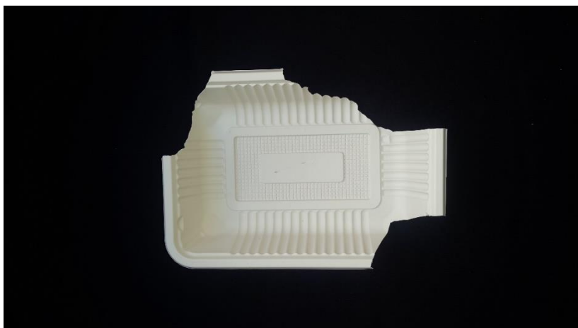
شکل ۲-۴ ظرف نمونه اول دارای عیب بزرگ
