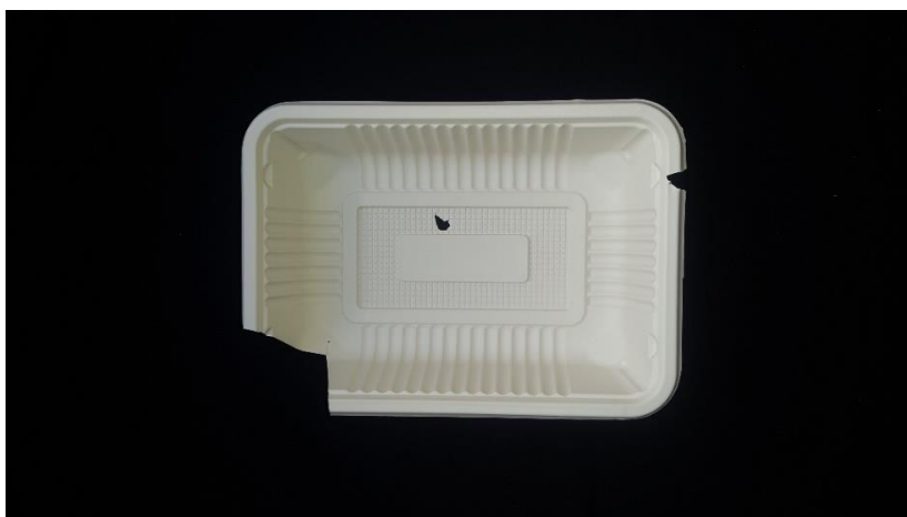
شکل ۳-۴ ظرف نمونه اول دارای عیب بزرگ و کوچک
