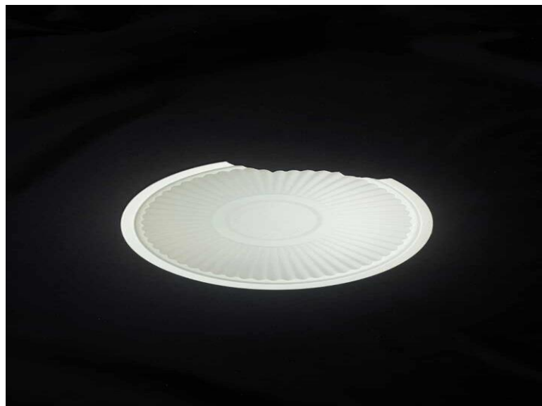
شکل ۴-۵ ظرف نمونه دوم دارای عیب بزرگ
