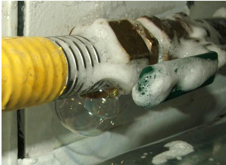
شکل ۲-۱۲- نشت یابی به وسیله کف صابون [۲۶]
