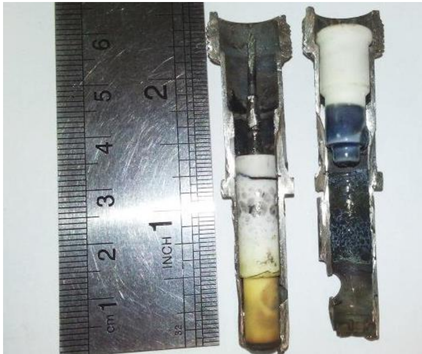
شکل ۳-۷- شمع برش خورده و محل قرارگیری سرامیک‌ها
