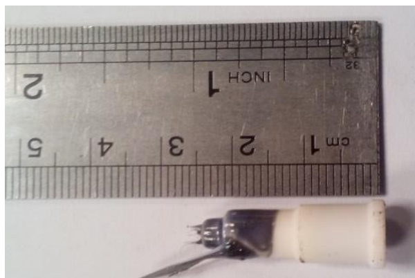
شکل ۳-۵- سرامیک ناحیه سرد شمع موتور جت J85 و چسب نگهدارنده آن
