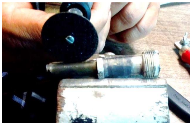
شکل ۳-۶- برش پوسته شمع موتور جت J85 با استفاده از فرز
