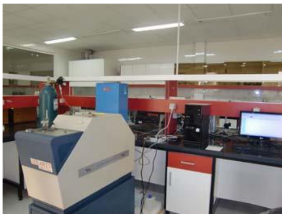
شکل ۳-۱۵- دستگاه آنالیز فلزات-کوانتومتری مدل SOLARIS CCD Plus
