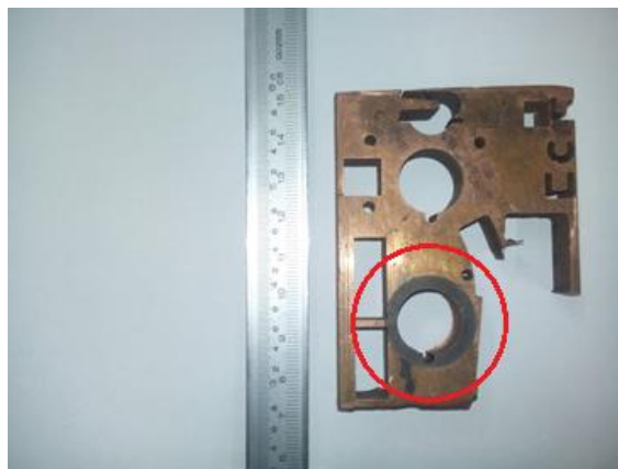
شکل ۳-۲۱- الکتروود مسی جهت ماشینکاری خار روی پوسته
