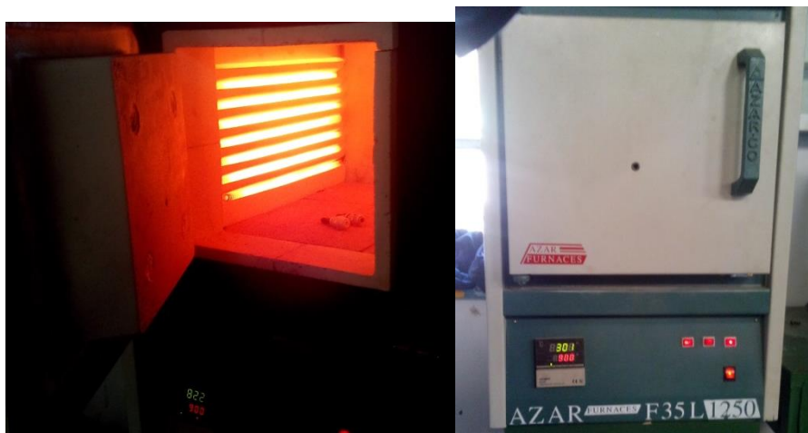
شکل ۳-۴- ذوب کردن چسب درون شمع با استفاده از کوره
