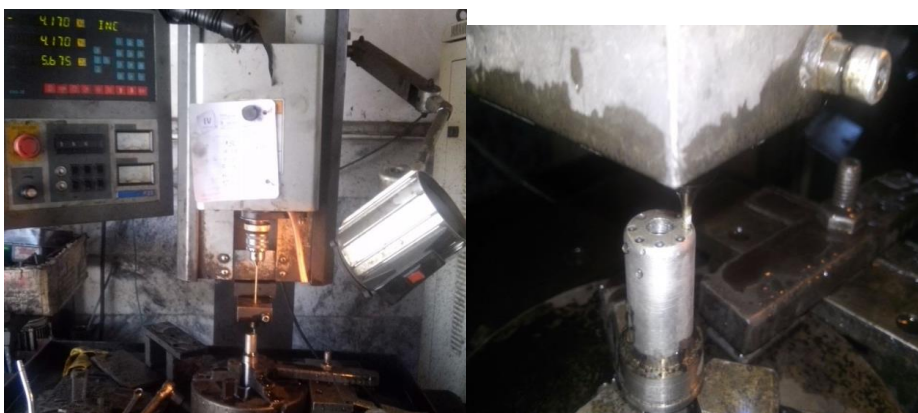
شکل ۳-۲۰- سوراخکاری قطعه با دستگاه سوپر دریل
