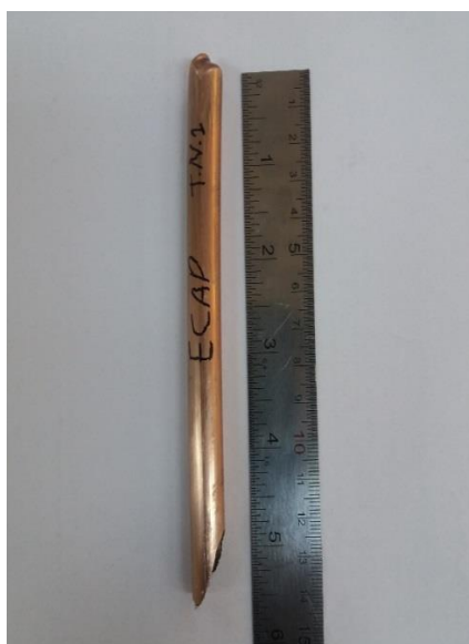
شکل ۳-۲- نمونه قطعه پاس اول ECAP.
