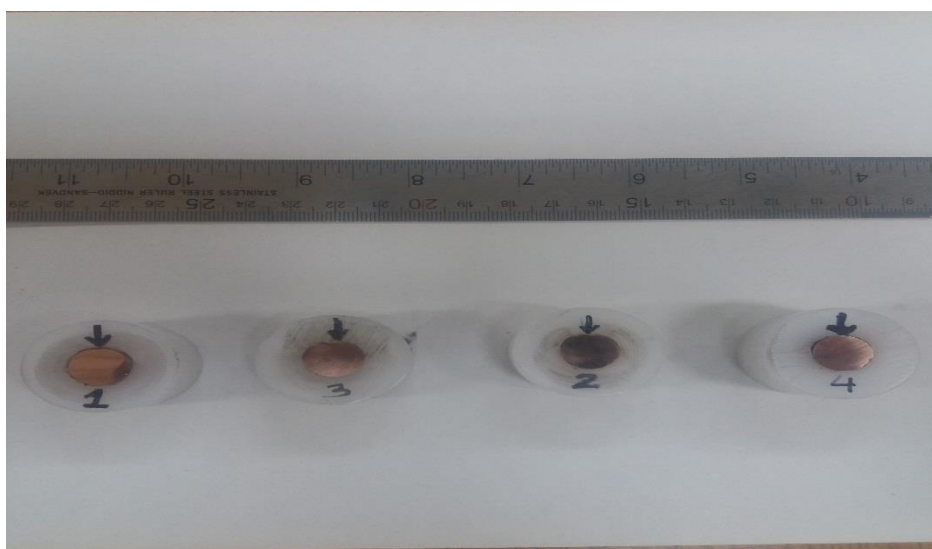
شکل ۲-۷- نمونه های آماده سازی شده سختی سنجی.
