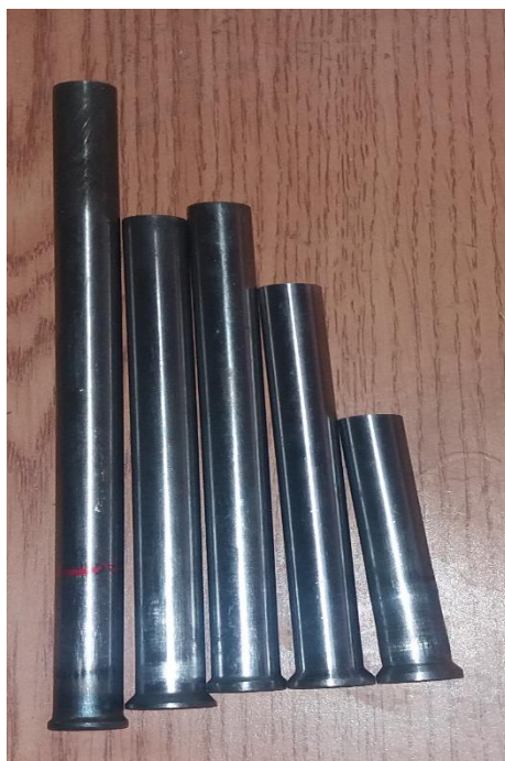
شکل ۲-۳- سنبه‌های قالب ECAP.
