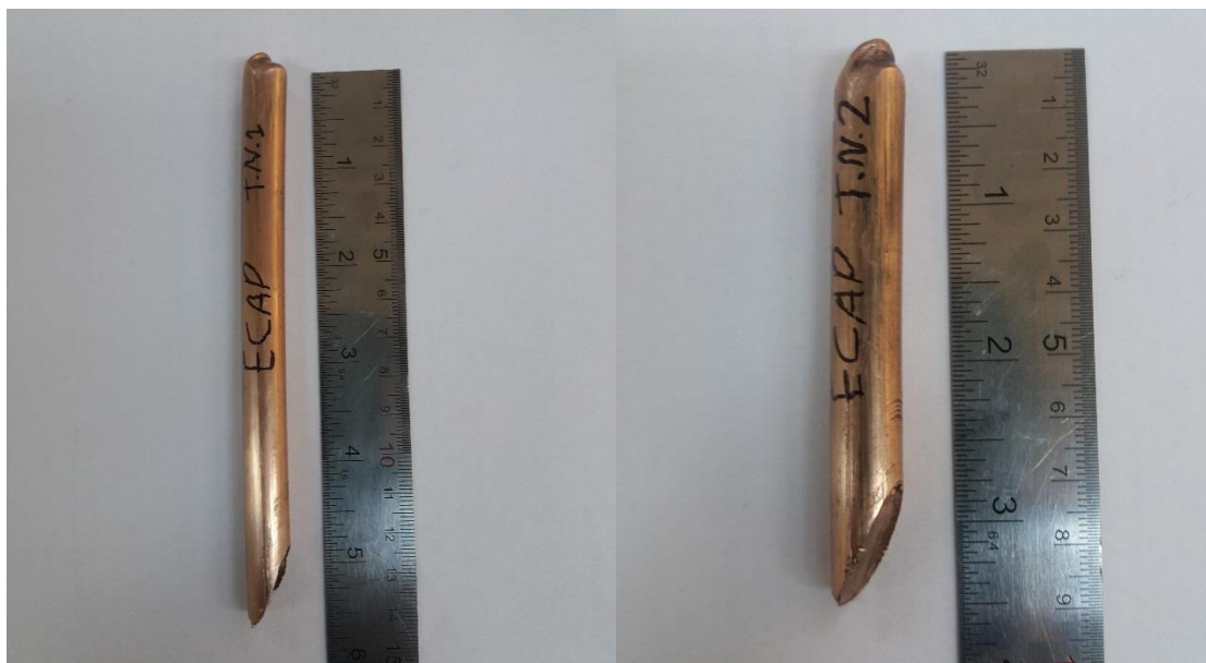
شکل ۲-۶- نمونه قطعات ECAP شده در پاس های متفاوت
