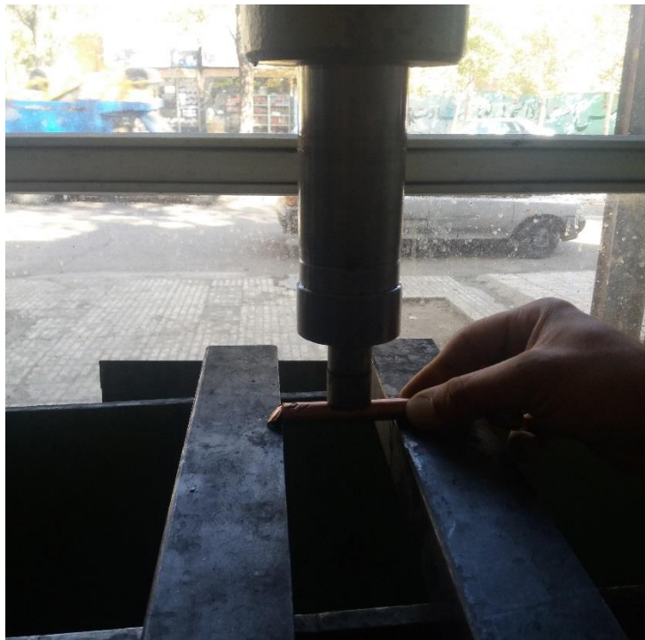
شکل ۲-۹- اعمال نیرو به کمک پرس هیدرولیکی.
