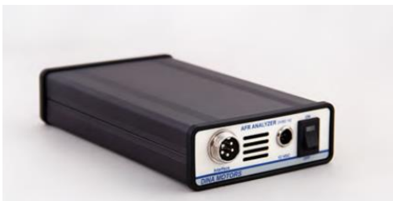
شکل ۲-۷: دستگاه خوانش نسبت سوخت به هوا (لامبدا)
