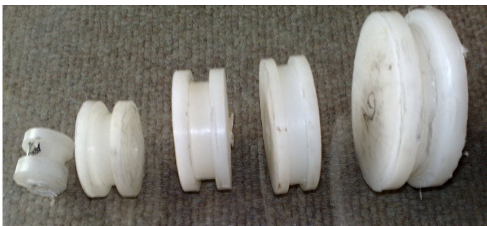
شکل (۳-۹): پولیهای استفاده شده برای تنظیم دور سیلندر
