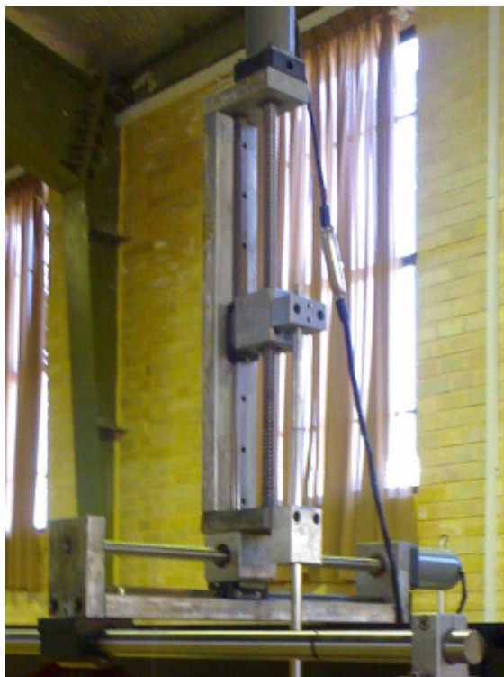
شکل (۳-۳): مکانیزم جابجاکننده پراب
