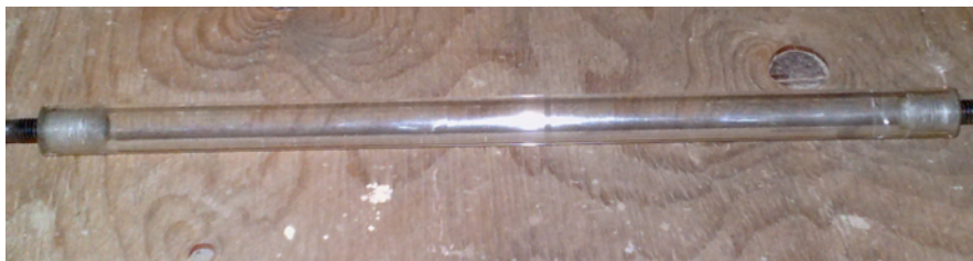
شکل (۳-۴): مدل استفاده شده از جنس پلکسی گلاس با قطر ۲۰ میلی‌متر
