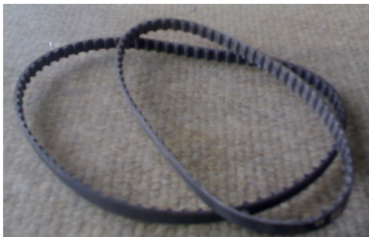
شکل (۳-۱۰): تسمه‌های دنده‌ای استفاده شده در انتقال نیرو از موتور به سیلندر
