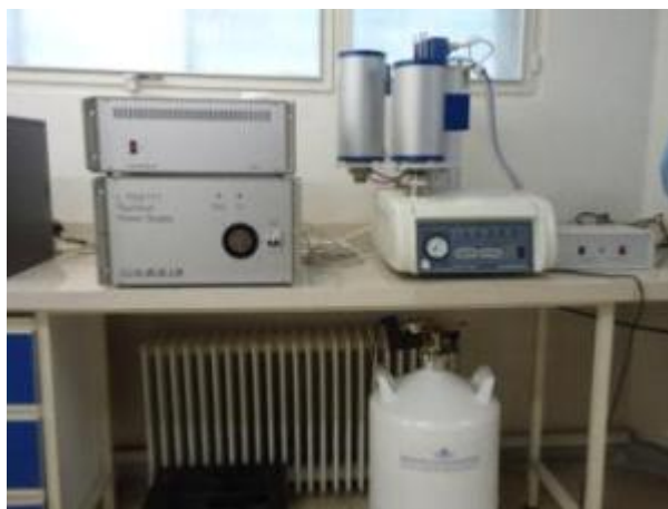
شکل (۳-۱۱) دستگاه STA PT1600 برای تحلیل توزین حرارتی
