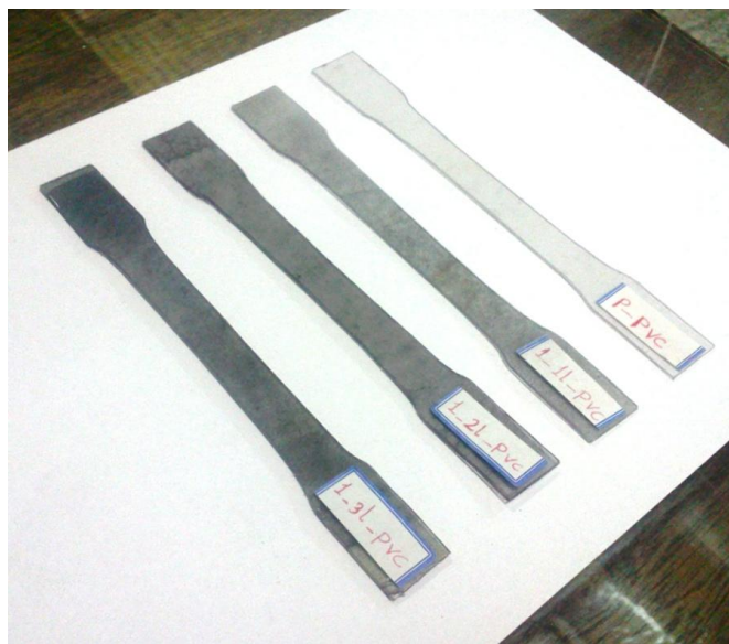
شکل (۵-۱) نمونه‌های استاندارد تهیه شده برای آزمایش کشش
