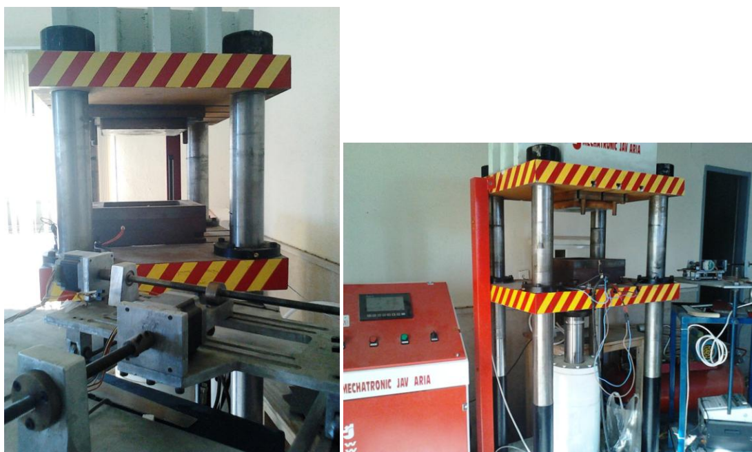
شکل (۳-۶) دستگاه پرس هیدرولیک، قالب، اسپری و متعلقات آن
