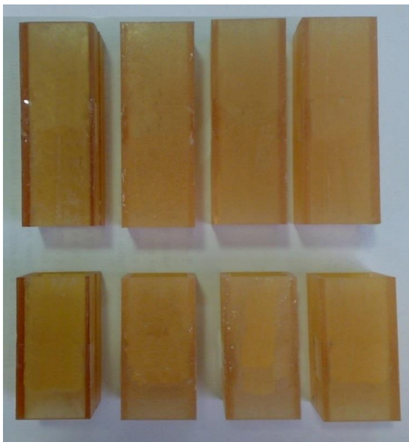
شکل ۴-۲۲: نمونه نانوکامپوزیتی قوطی شکل با دو ارتفاع ۶۰ و ۹۰ mm.
