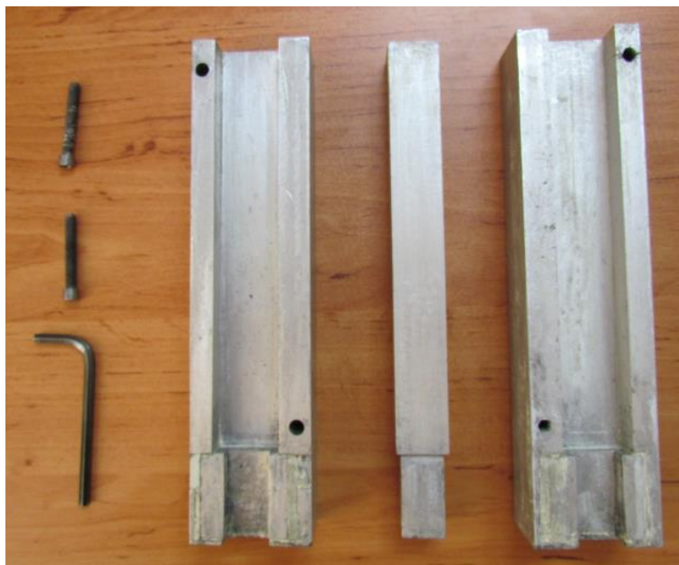
شکل ۴-۲۰: قالب آلومینیومی برای ساخت نمونه‌های جدار نازک قوطی شکل
