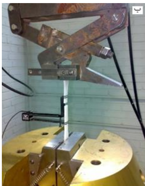
شکل ۴-۱۰: الف) نمونه تحت آزمایش کشش توسط دستگاه سروهیدرولیک اینسترون ب) بزرگنمایی
