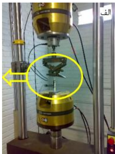
شکل ۴-۱۰: الف) نمونه تحت آزمایش کشش توسط دستگاه سروهیدرولیک اینسترون ب) بزرگنمایی
