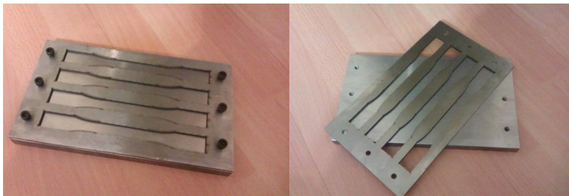
شکل ۴-۷: قالب تهیه نمونه آزمایش کشش بر اساس استاندارد ASTM D 638
