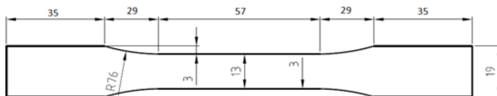
شکل ۴-۶: نقشه و ابعاد ساخت نمونه آزمایش کشش
