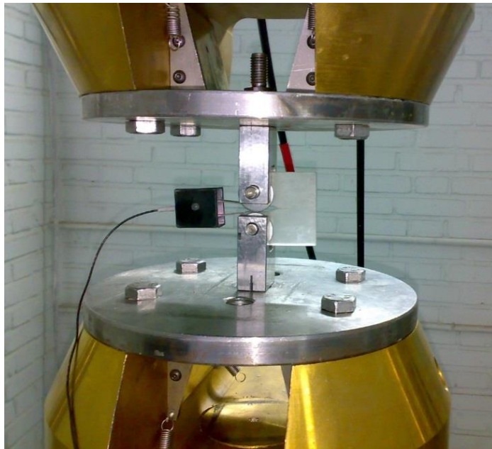
شکل ۴-۱۴: نمونه تحت آزمایش چقرمگی شکست توسط دستگاه اینسترون ۸۸۰۲
