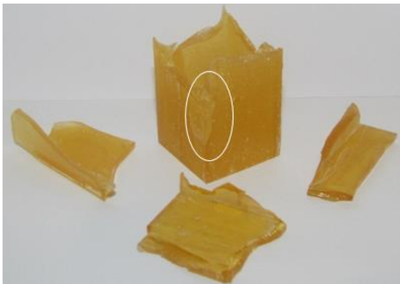
شکل ۵-۲۳: شکست ترد نمونه و ایجاد لبه های تیز بر اثر گسترش ترک‌های محوری و جدا شدن تکه‌های بزرگ.
