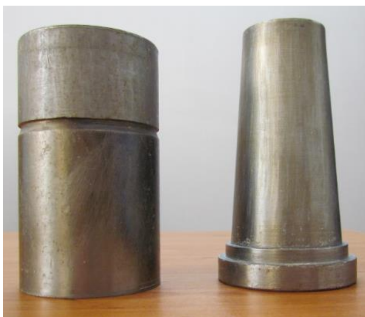
شکل ۴-۲۱: قالب فولادی برای ساخت نمونه‌های جدار نازک قوطی شکل
