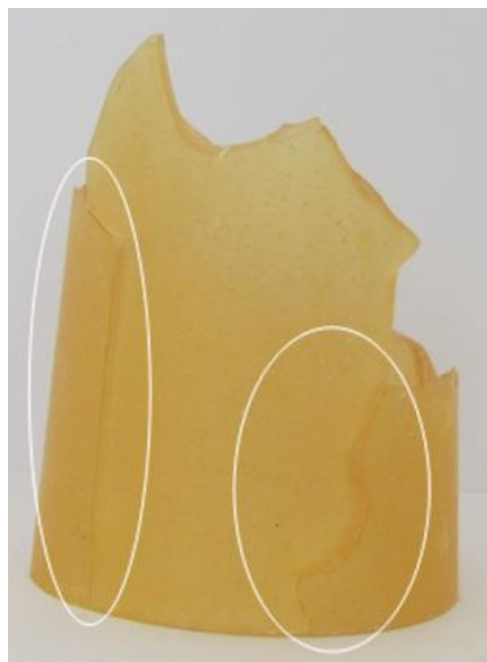
شکل ۵-۲۵: شکست ترد نمونه بر اثر ترک‌های محوری
