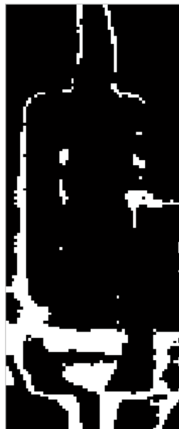
شکل ۴-۱ استخراج رنگ قهوه‌ای در تصویر یک مقاومت
