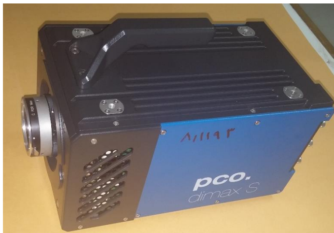
شکل ۱۶- دوربین سرعت بالا ( pco. Dimax S/4000 frames per second )
