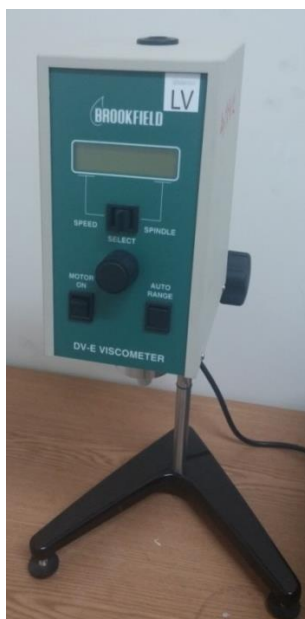
شکل ۱۸- دستگاه ویسکومتر شرکت BROOKFIELD مدل DV-E /LV
