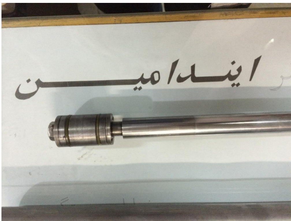
شکل ۲-۲۱ پیستون دمپر MR
