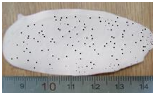
شکل ۳-۵: مشاهده تخلخل زیاد ناشی از عدم هوازدایی دوغاب ریخته‌گری نواری
