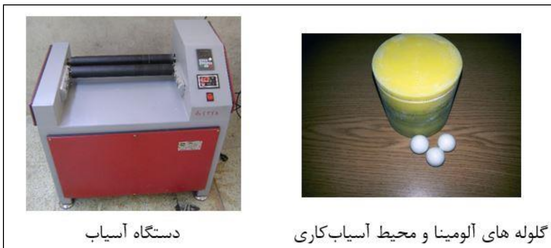
شکل ۲-۲: محیط آسیاکاری جهت تهیه دوغاب ریخته‌گری نواری
