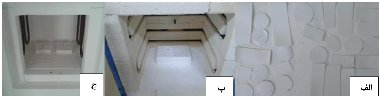
شکل ۲-۶: (الف) نوارهای خام برش‌خورده (ب) کوره مربوط به خارج کردن مواد آلی (ج) کوره مربوط به پخت نمونه‌ها
