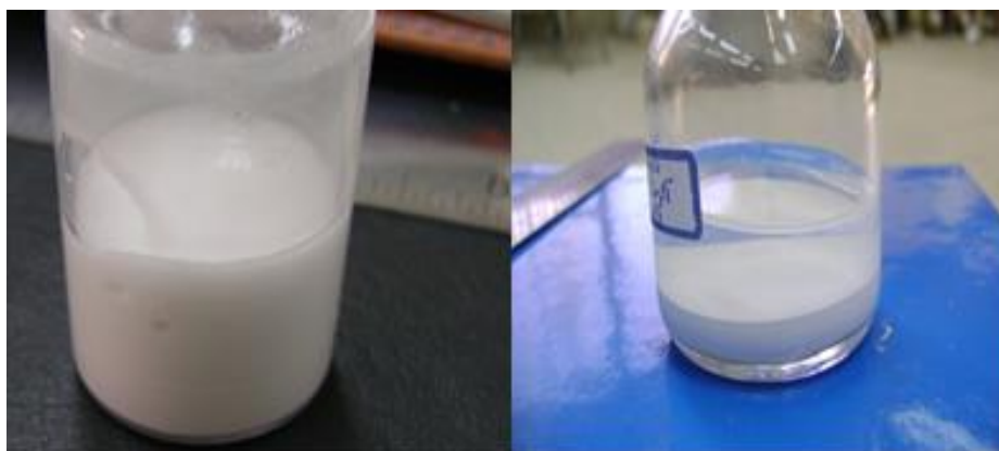
شکل ۳-۲: مشاهده عدم پایداری دوغاب ناشی از کم بودن مقدار پراکنده‌ساز
