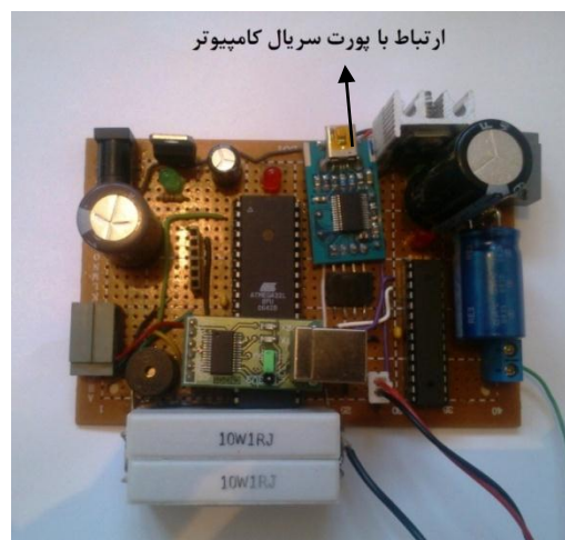
شکل (۵-۱۶) مدار کنترلی واسط برای هدایت حرکت موتور محرک دستگاه توانبخشی آرنج
