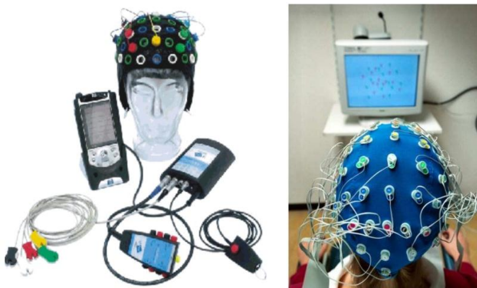
شکل (۱-۱) وسایل مورد استفاده در سیستم EEG. تجهیزات برداشت سیگنال شامل تعدادی الکتروود، یک تقویت کننده سیگنال و دستگاه ثبت و نمایش داده ها می باشد.
