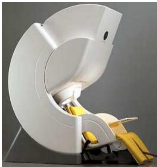
شکل (الف-۲) تصویری از یک دستگاه عکس برداری مغناطیسی مغزی. به علت بزرگ بودن تجهیزات، سیستم های MEG در زمینه BCI غیرقابل استفاده می باشند.
