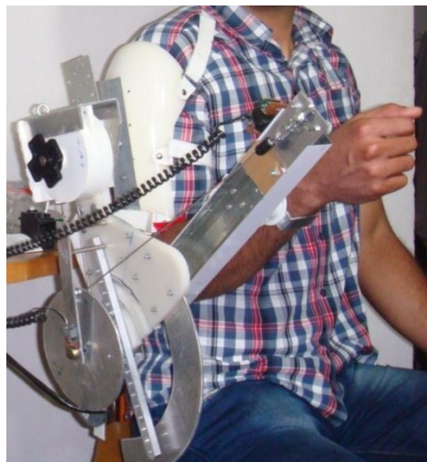
شکل (۵-۱۴) نحوه اتصال دستگاه توانبخشی آرنج به دست کاربر
