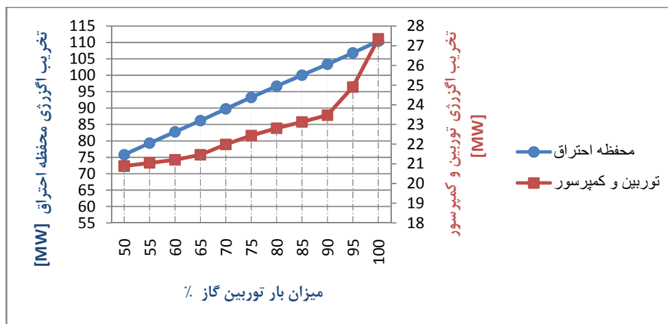
شکل ۴-۳۸: نمودار تغییرات تخریب اگزرژی محفظه احتراق، کمپرسور و توربین گاز با درصد بار توربین گاز
