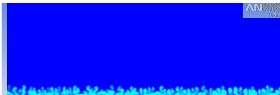
شکل (۴-۲۷) : حباب‌های بخار آب ایجاد شده روی دیواره بیرونی تیوب در ثانیه ۰/۰۱
