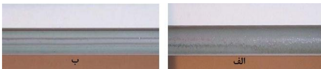
شکل (۱۹-۲): الف) جریان حلقوی ب) جریان لایه‌ای [۱۹]
