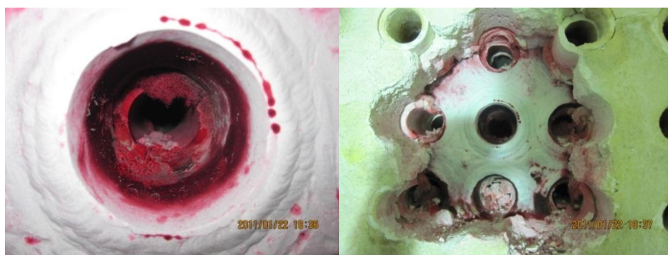
شکل (۷-۲) : آسیب‌های پدید آمده جوش بین تیوب و تیوب شیت برای بار سوم بعد از تعمیرات [۹]
