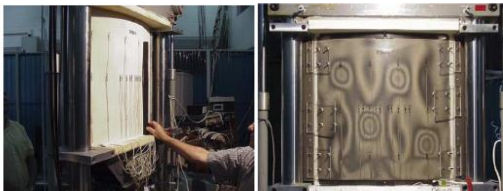
شکل ۵-۱- پانل مورد آزمایش قبل و بعد از بارگذاری [۹]
