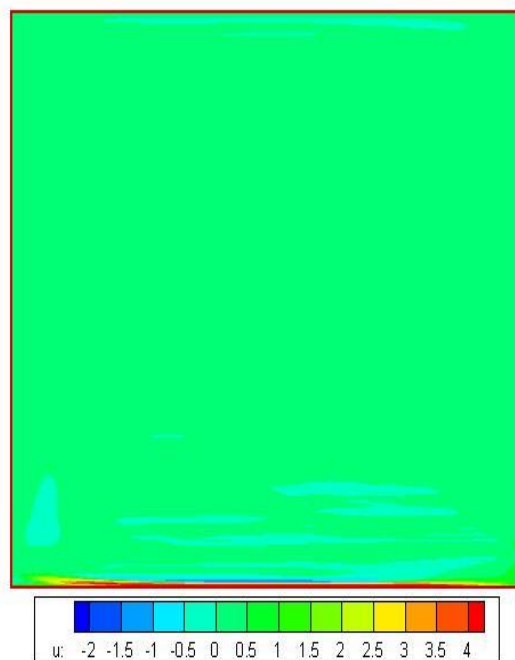
شکل ۵-۱۸- کانتورهای سرعت محوری در G=0.036 , Re_\phi=1.038e+6 , C_w=13366
