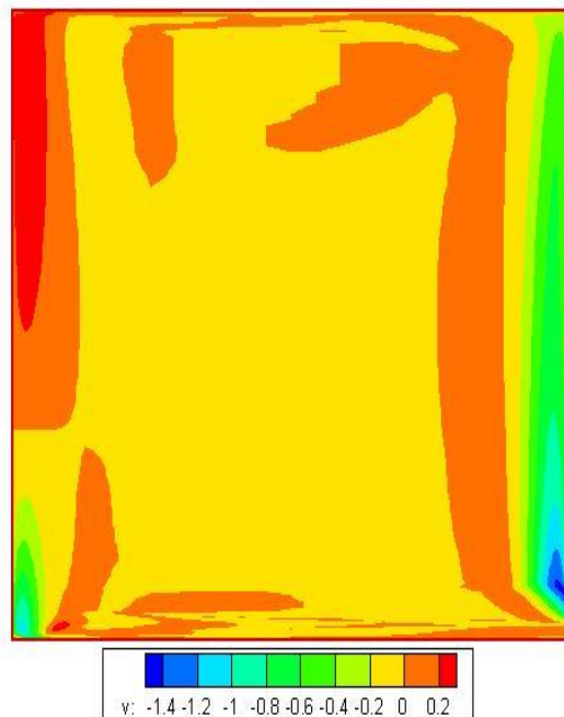
شکل ۵-۱۵- کانتورهای سرعت شعاعی در G=0.036 , Re_\phi=1.038e+6 , C_w=1585
