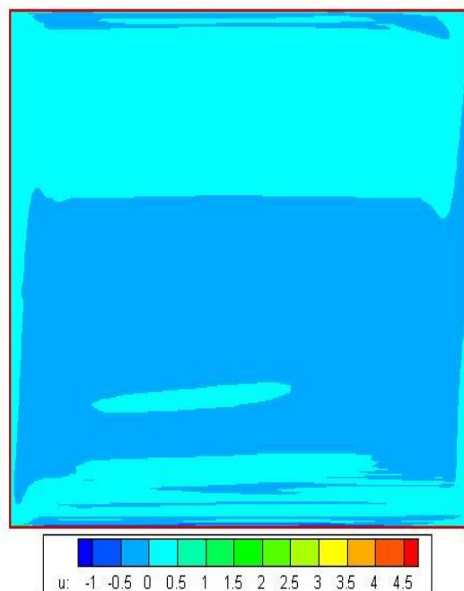
شکل ۵-۱۲- کانتورهای سرعت محوری در G=0.036 , C_w = ۵۱۵۹ , Re_\phi = 4.151e+6
