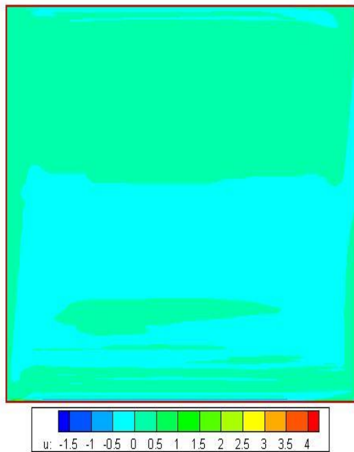
شکل ۵-۱۰- کانتورهای سرعت محوری در G=0.036 , C_w = ۵۱۵۹ , Re_\phi = 2.076e+6
