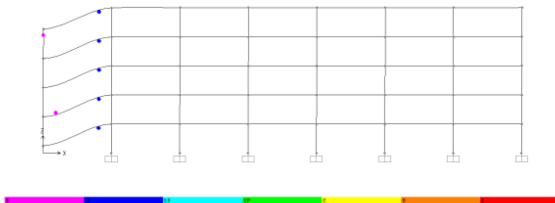
شکل ۴-۴۵. نحوه تغییر شکل و ایجاد مفاصل پلاستیک در سازه پس از اتمام تحلیل ( L=7.5m, CB, x-z )
