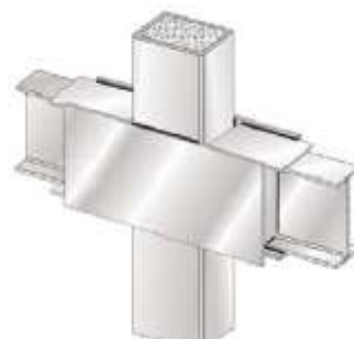
شکل ۲-۳. مقطع فولادی پر شده
