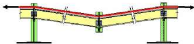
شکل ۲-۴. کابل زنجیره‌وار برای انتقال بار از
