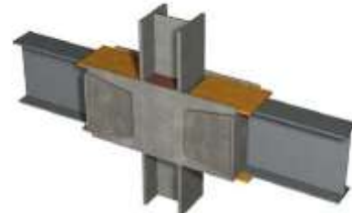
شکل ۲-۵. اتصال فولادی با Side Plate (Crawford, 2002)
