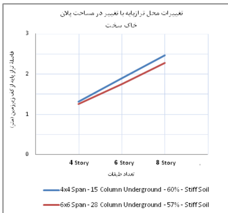
شکل (۵ ۱۵): تأثیر مساحت پلان بر محل تراز پایه بر روی خاک سخت
