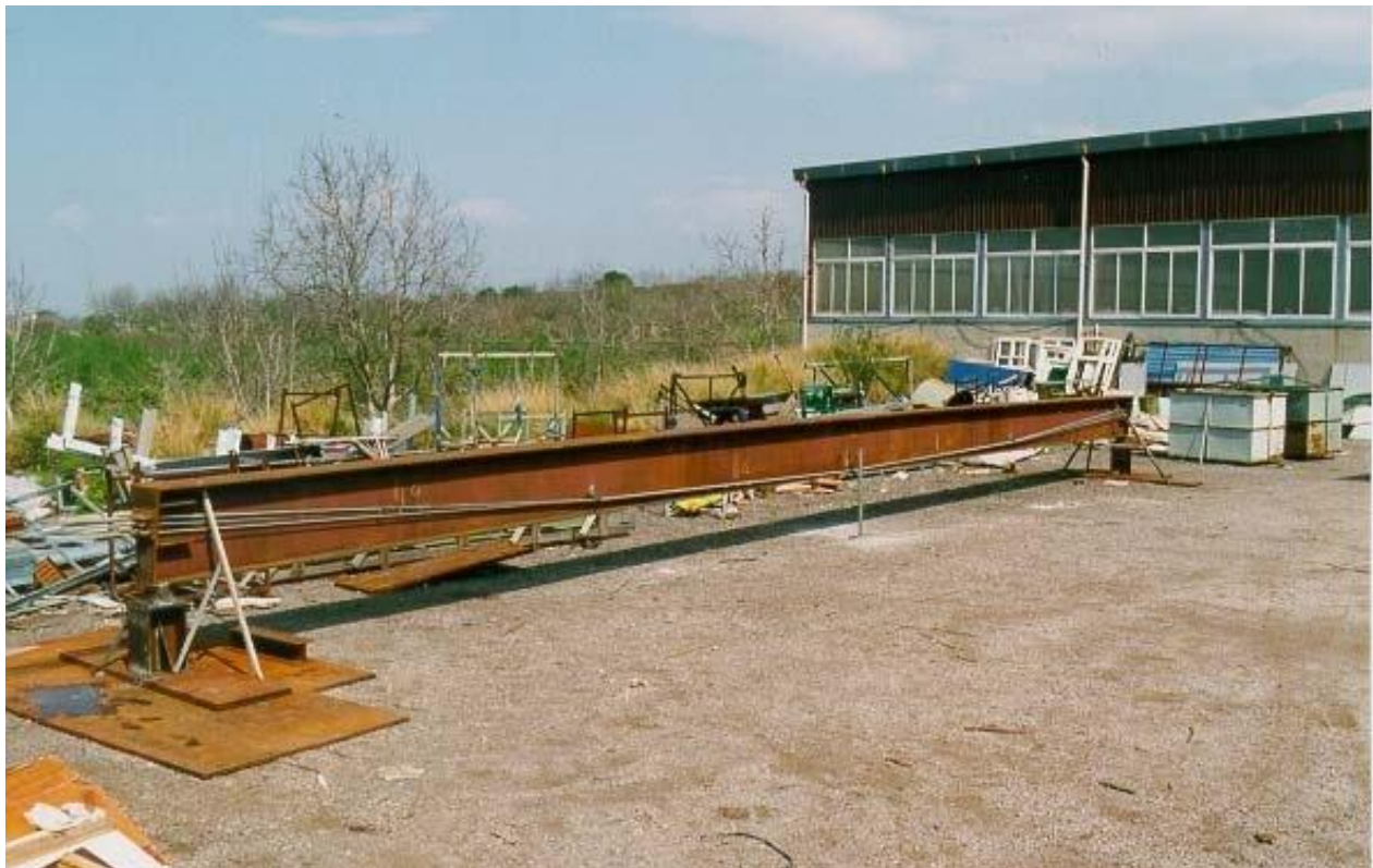
شکل ۲-۱۰ پیش تنیدگی به واسطه کابل های آویزان
