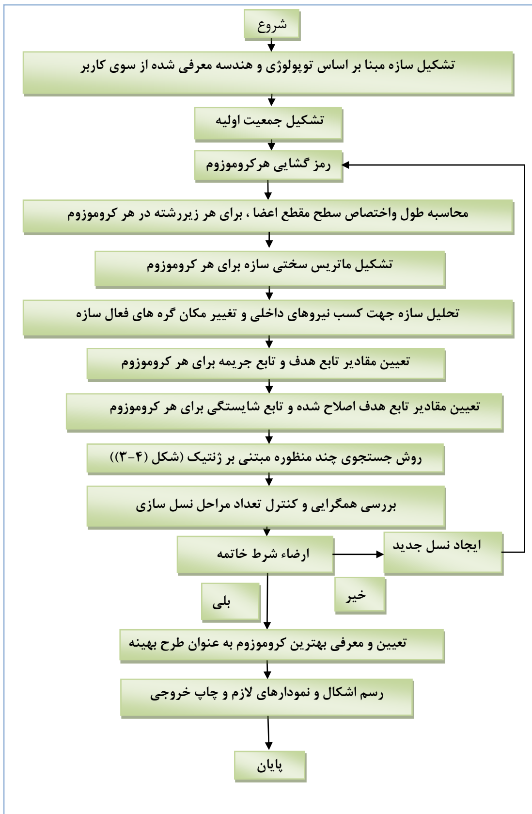
شکل (۲-۴) - فلوچارت الگوریتم جستجوی چند منظوره مبتنی بر ژنتیک برای بهینه یابی مقاطع سازه ها
