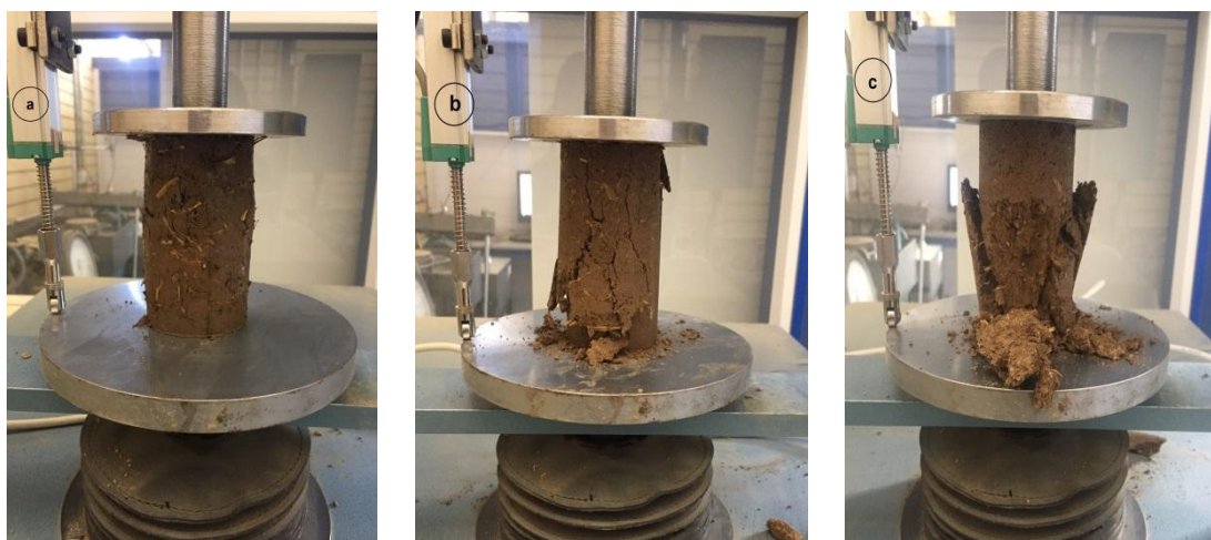
شکل (۴-۲۷) گسیختگی نمونه‌های حاوی ۴٪ سیمان و ۰/۲۵٪ الیاف با زمان‌های عمل‌آوری متفاوت. (a) نمونه عمل‌آوری نشده. (b) نمونه ۷ روزه. (c) نمونه ۲۸ روزه.
