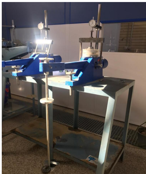
شکل (۷-۳) دستگاه تحکیم در حال بارگذاری نمونه رمبندگی.
