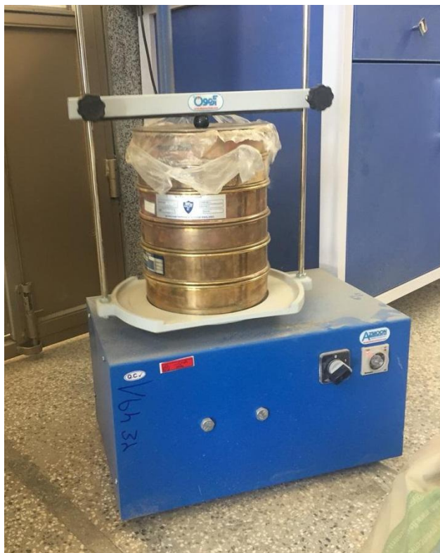
شکل (۳-۳) دستگاه شیکر و الک‌های مورد استفاده جهت انجام آزمایش دانه‌بندی.
