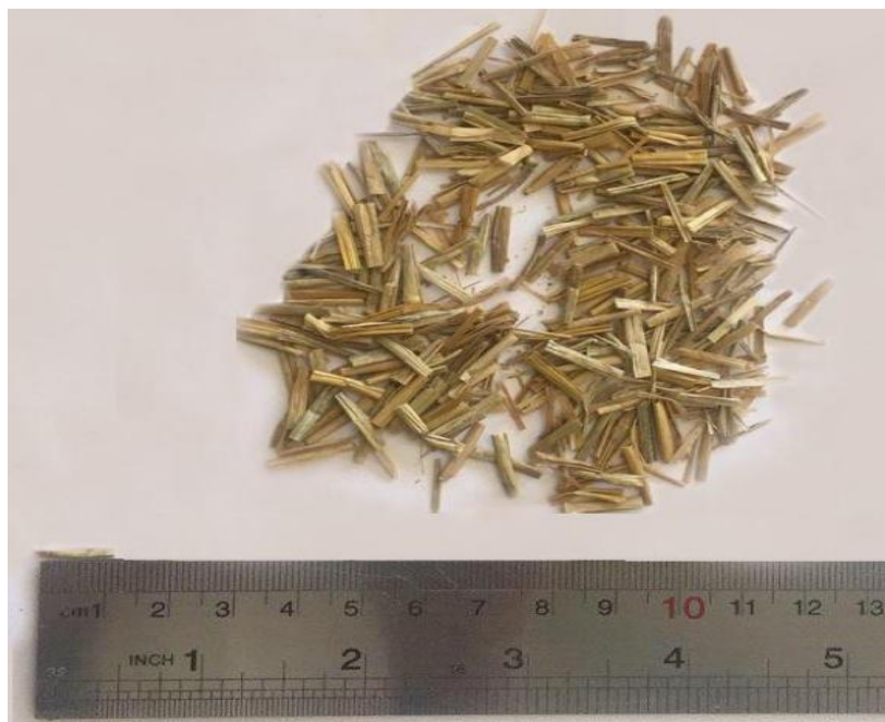
شکل (۳-۹) الیاف ساقه برنج به طول 1 سانتی متر و قطر میانگین 0.2 سانتی متر
