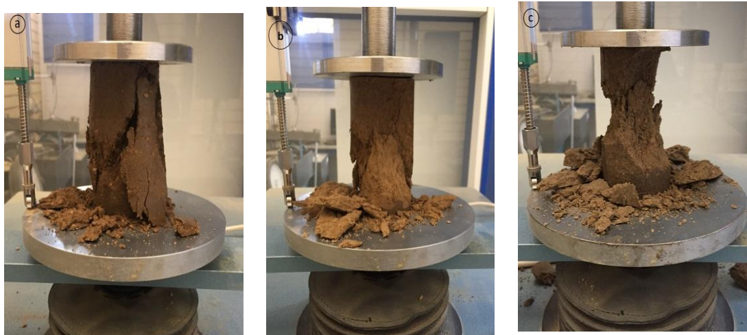
شکل (۴-۸) گسیختگی نمونه‌های عمل‌آوری نشده و (a) حاوی ۴٪ سیمان. (b) حاوی ۸٪ سیمان. (c) حاوی ۱۲٪ سیمان.
