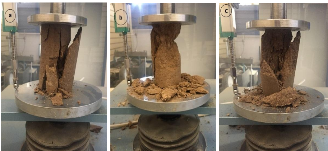
شکل (۴-۱۴) گسیختگی نمونه‌های ۲۸ روزه و (a) حاوی ۴٪ سیمان. (b) حاوی ۸٪ سیمان. (c) حاوی ۱۲٪ سیمان.
