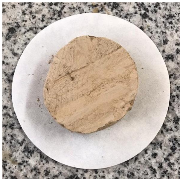
شکل (۳-۶) نمونه دست‌نخورده جهت انجام آزمایش پتانسیل فروریزش.
