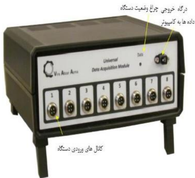
شکل (۳-۱۲) دیتالاگر ۸ کاناله مورد استفاده
