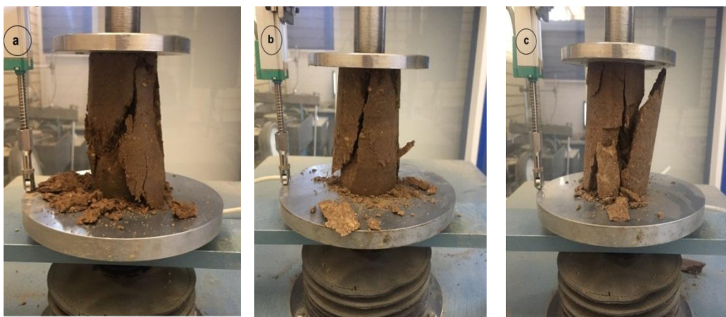
شکل (۱۷-۴) گسیختگی نمونه‌های حاوی ۴٪ سیمان ۲۸ روزه و (a) عمل‌آوری نشده . (b) ۷ روزه. (c) ۲۸ روزه.
