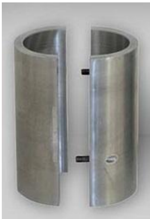
شکل (۳-۱۰) قالب نمونه‌ساز آزمایش مقاومت فشاری محدود نشده.
