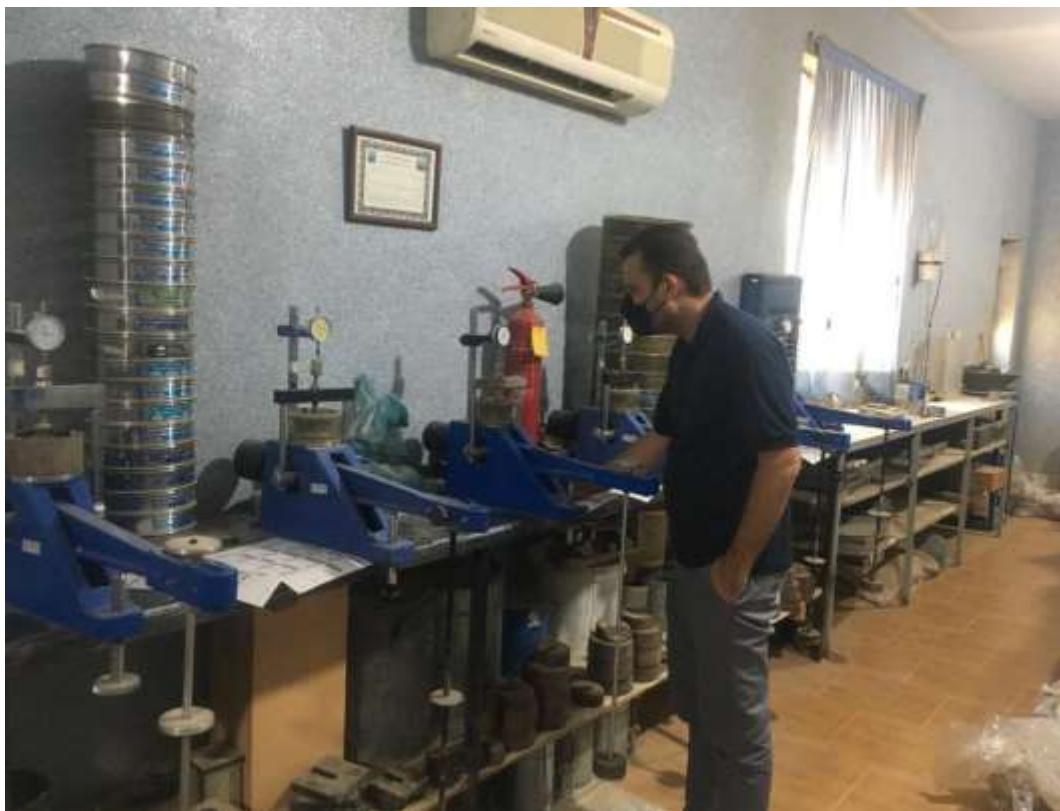
شکل ۳-۱۷ انجام آزمایش تورم
