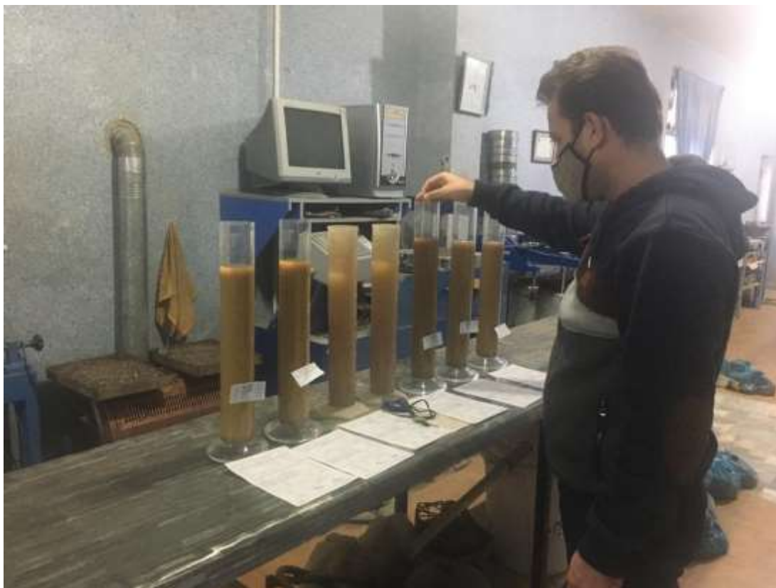
شکل ۳-۱۰ انجام آزمایش هیدرومتری مضاعف
