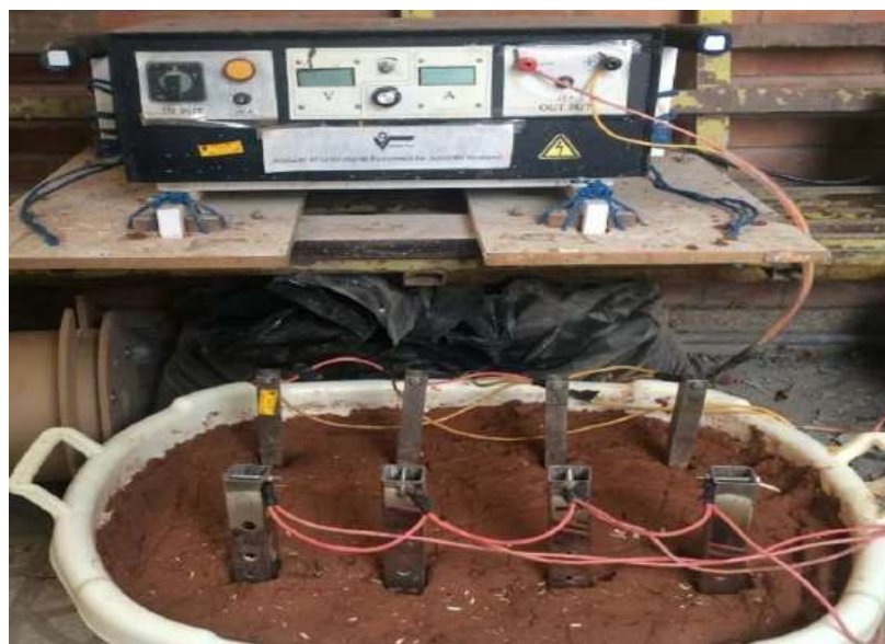
شکل ۲-۱۵ نمایی از نحوه استفاده از الکترواسموز [۲۵]
