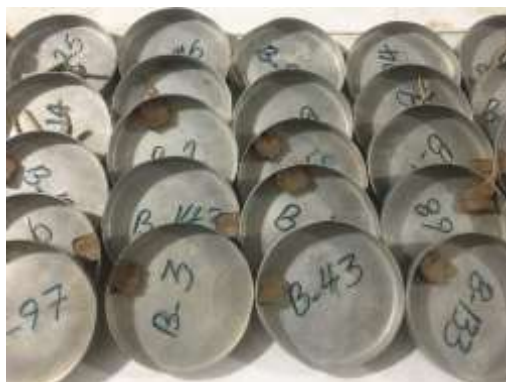
شکل ۳-۵ انجام آزمایش تعیین حدود آتربگ
