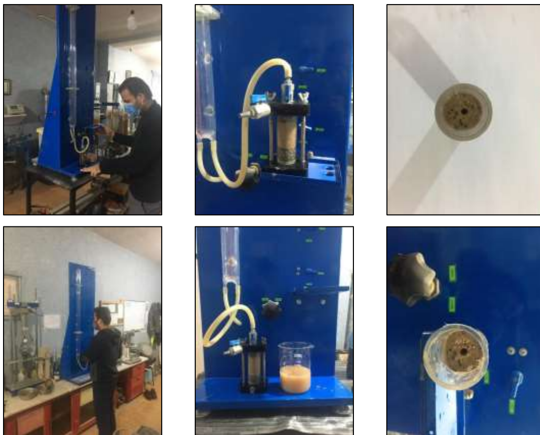
شکل ۳-۱۴ انجام آزمایش پین هول
