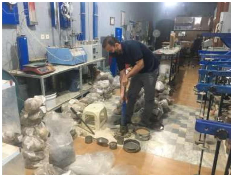
شکل ۳-۸ انجام آزمایش تراکم
