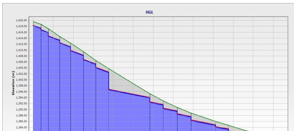
شکل ۸-۴. پروفیل طولی مسیر ابتدایی در بخش بالادست شبکه فاضلاب
