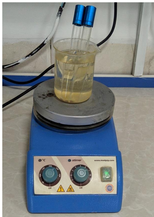
شکل ۳-۴-آماده سازی و همدمایی محیط کشت برای انجام آزمون توسط بن ماری
