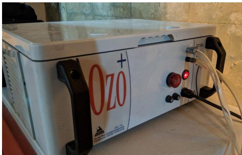
شکل ۳-۲- دستگاه ازن ژنراتور COG5
