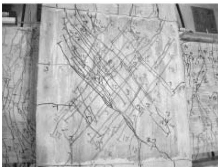
شکل ۲-۱۵ اتصال تیر-ستون HPFRCC [۵۹]
