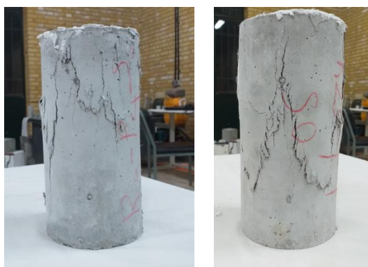
شکل پ-۲۶ الگوی ترک نمونه بتنی حاوی ۰/۴٪ الیاف پلی پروپیلن در آزمایش فشاری
