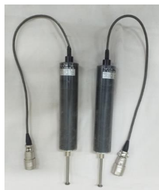
شکل ۳-۳۴ LVDT با دقت ۰.۰۵.۰ میلی‌متر
