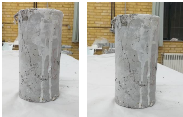
شکل پ-۲۸ الگوی ترک نمونه بتنی حاوی ۰/۴٪ الیاف پلی پروپیلن و ۱٪ الیاف فولادی در آزمایش فشاری
