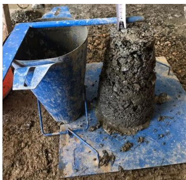
شکل ۳-۳۱ نحوه محاسبه ارتفاع ریزش بتن
