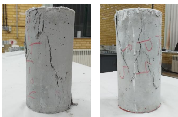
شکل پ-۲۷ الگوی ترک نمونه بتنی حاوی ۰/۴٪ الیاف پلی پروپیلن و ۰/۵٪ الیاف فولادی در آزمایش فشاری
