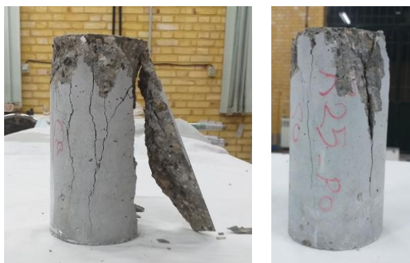
شکل پ-۲۵ الگوی ترک نمونه بتنی فاقد الیاف در آزمایش فشاری
