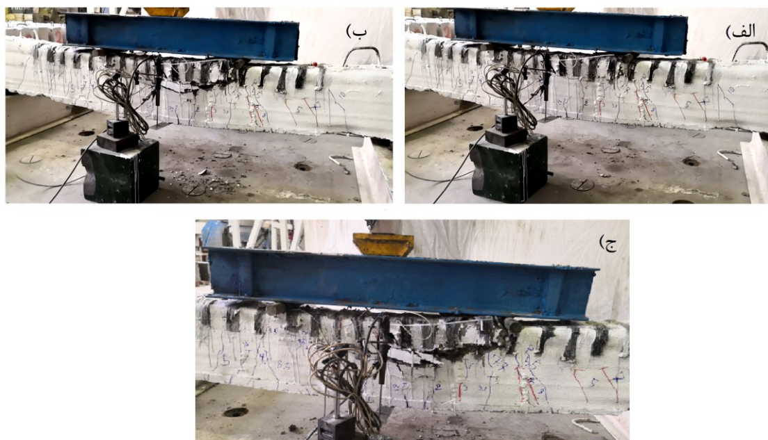
شکل ۴-۲۸ ترک‌های نمونه R.D.3 پیش از وقوع شکست
