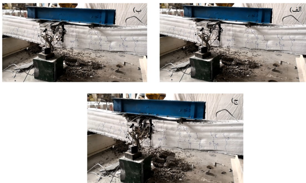
شکل ۴-۴۴ ترک‌های نمونه S.C.Cube در لحظات قبل از شکست
