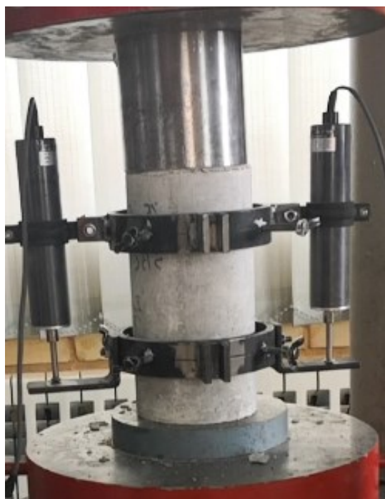
شکل ۳-۱۵ تست فشاری نمونه‌های استوانه‌ای بتن پلی‌مردار
