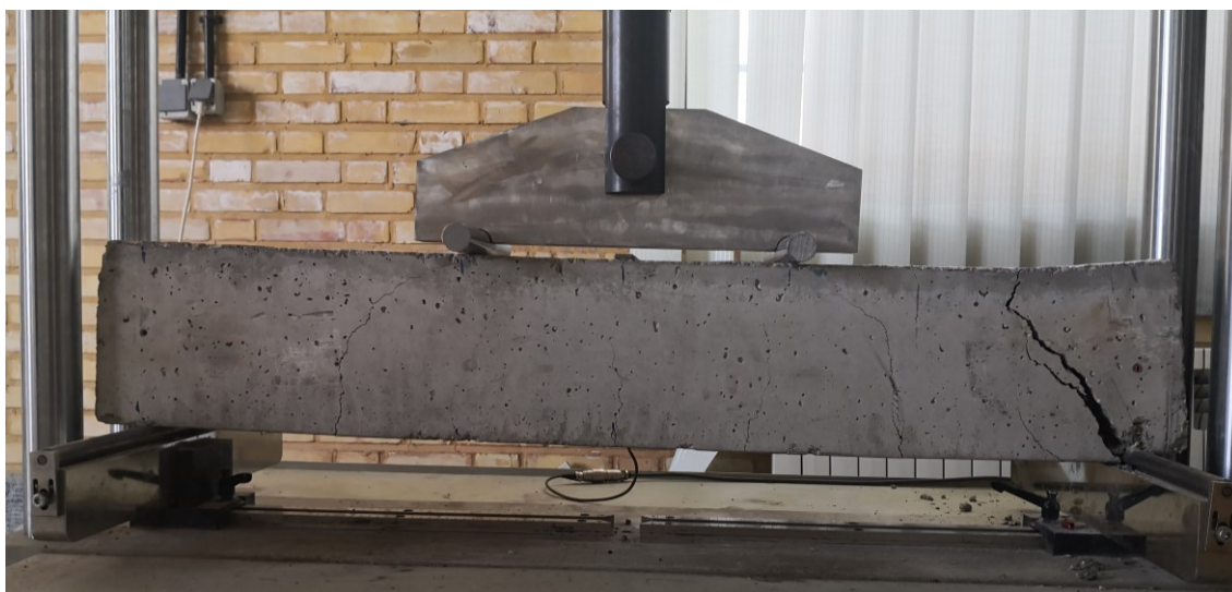
تصویر ۲ نخستین نمونه اولیه بعد از آزمایش خمش ۴ نقطه
