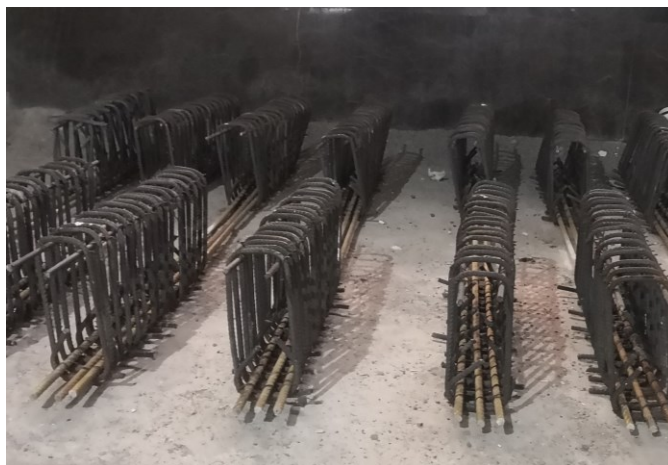
شکل ۴-۱۱ چند نمونه تیر آرماتور بندی شده
