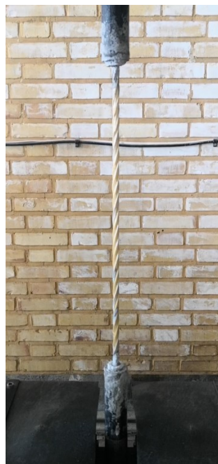
شکل ۳-۹ تست کشش میلگرد های GFRP شرکت آریانا سازه
