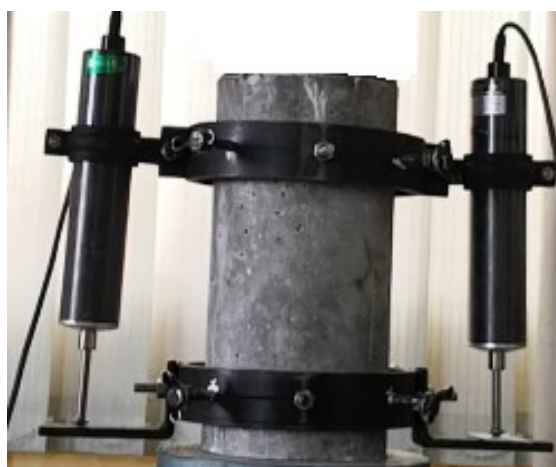
شکل ۳-۱۳ ستاپ تست مقاومت فشاری بتن
