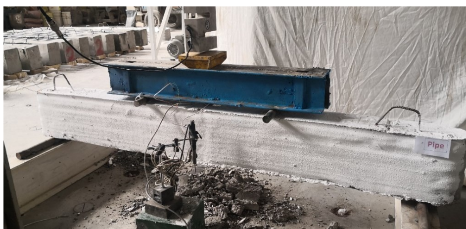
شکل ۴-۲۳ یک نمونه تیر پیش از بارگذاری
