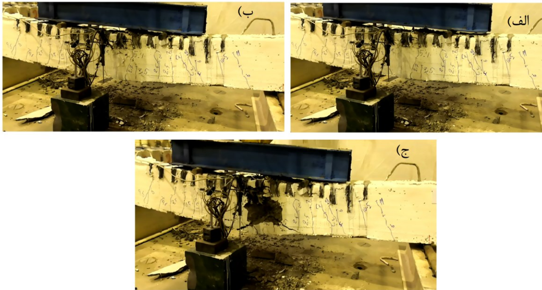
شکل ۴-۳۰ ترک های نمونه R.D.5 در لحظات پایانی شکست
