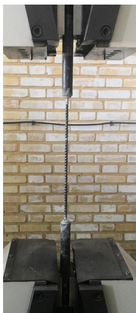
شکل ۳-۷ تست کشش میلگرد GFRP شرکت کامپوزیت آسیا
