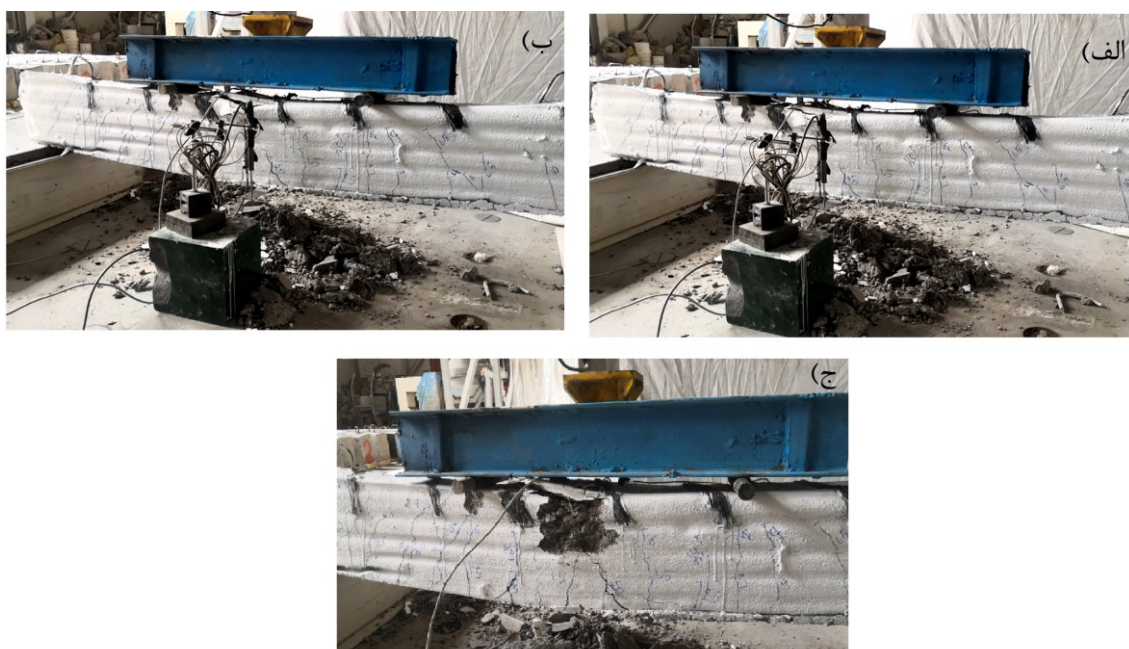
شکل ۴-۳۹ ترک های نمونه S.D.30 در لحظات پایانی شکست
