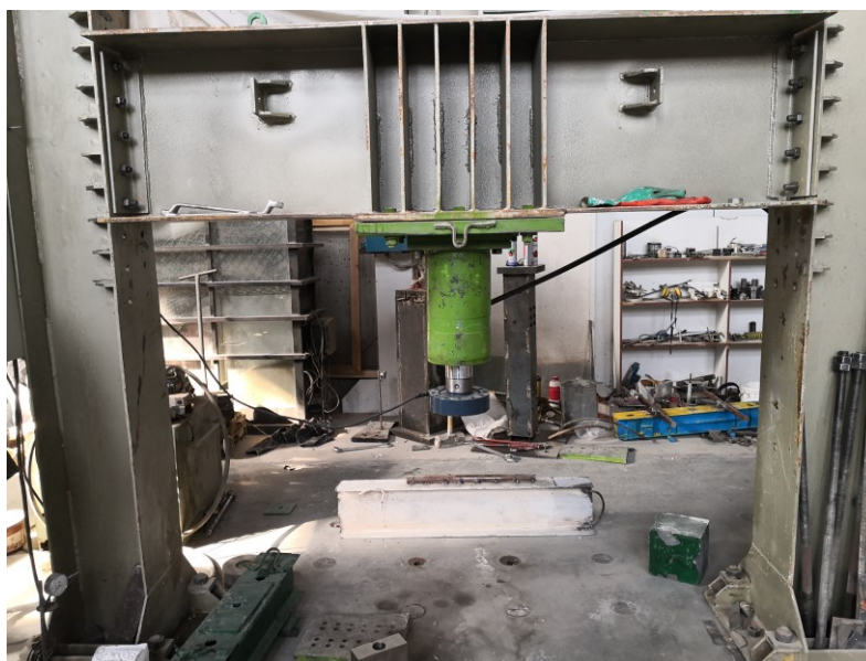
شکل ۴-۲۲ قاب صلب و جک اعمال نیرو
