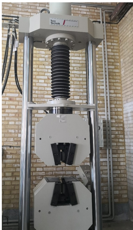
شکل ۳-۴ دستگاه تست کشش میلگرد GFRP
