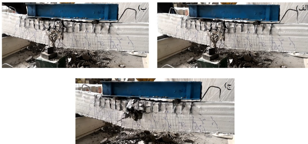
شکل ۴-۳۵ ترک های نمونه S.D.10 در لحظات پایانی شکست
