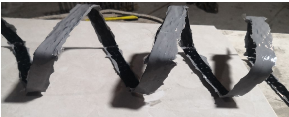
شکل ۴-۱۳ نوارهای CFRP آماده شده برای نمونه S.C.cube
