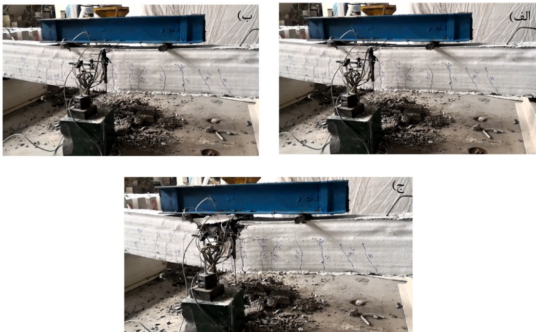
شکل ۴-۶ ترک های نمونه S.C.Pipe در لحظات قبل از شکست
