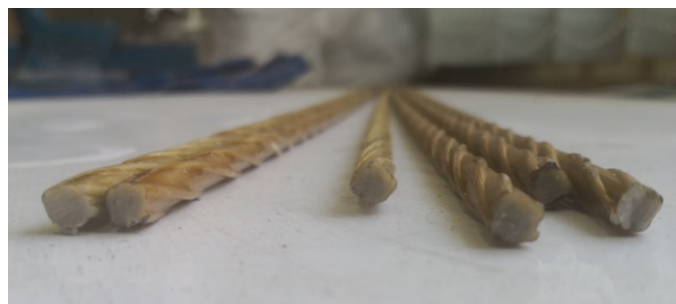
شکل ۳-۳ میلگرد های GFRP شرکت آریانا سازه
