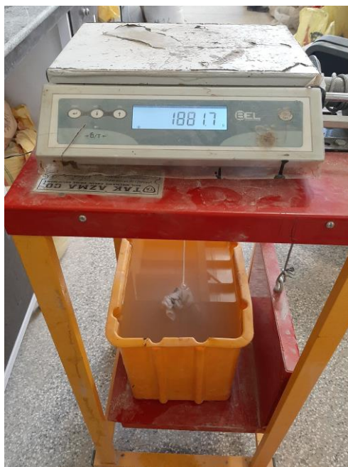
شکل ۴-۱۶ : وزن مصالح غوطه ور در آب
