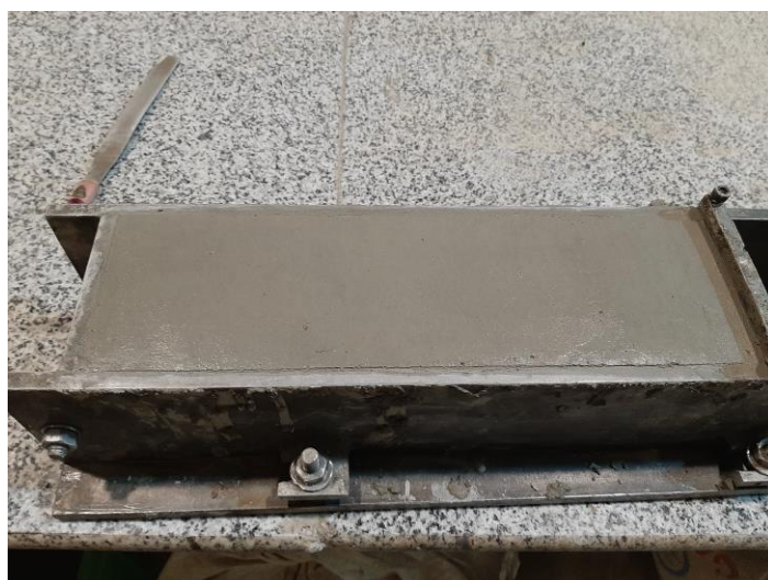
شکل ۴-۲۷: نمونه تیری بتن غلتکی
