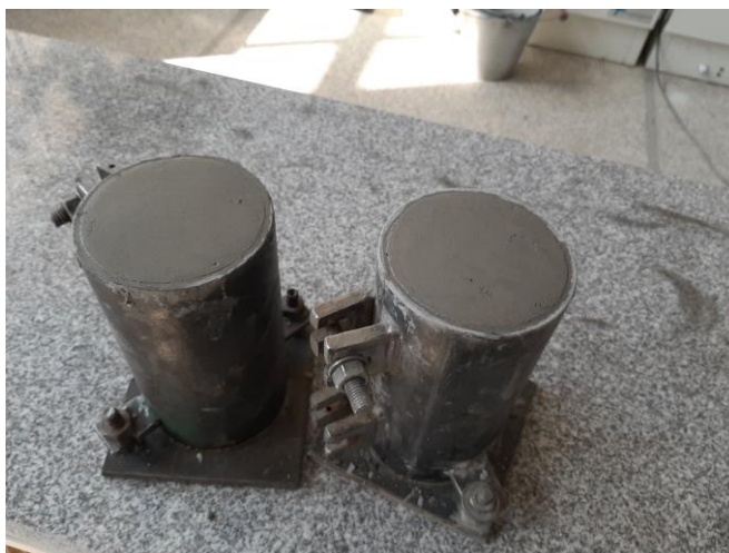
شکل ۴-۲۴ : نمونه استوانه بتن غلتکی
