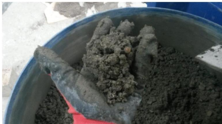
شکل ۳-۱ : چسبندگی و شل بودن مخلوط تازه
