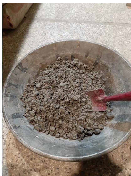
شکل ۴-۲۳: مخلوط نهایی نمونه استوانه
