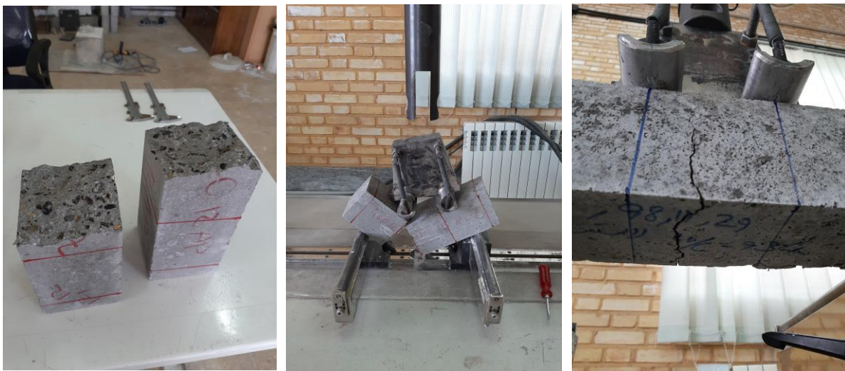
شکل ۵-۱۵: شکست تیر بتنی در دستگاه آزمایش
