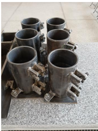
شکل ۴-۲۲: قالب نمونه استوانه
