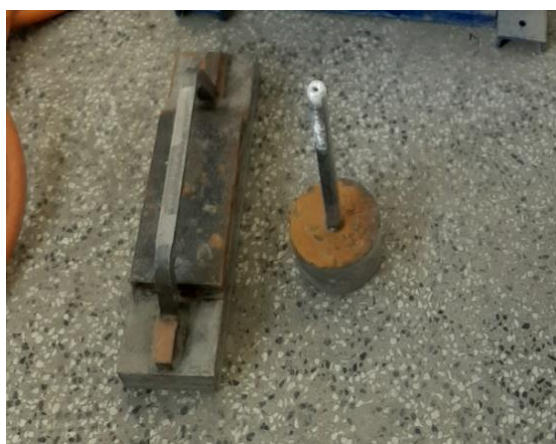
شکل ۴-۲۱ : وزنه سربار نمونه تیری
