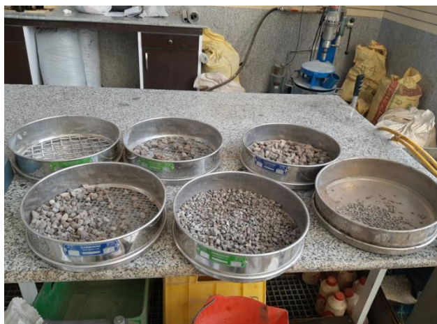
شکل ۴-۵: الکهای خارج شده از دستگاه لرزاننده
