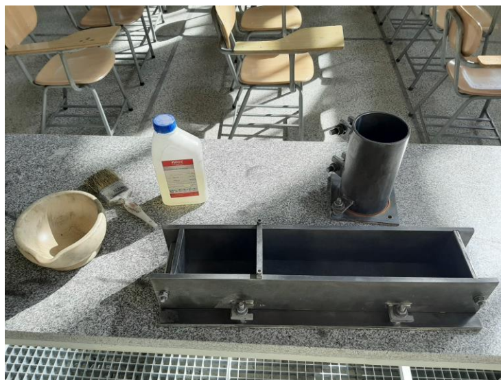
شکل ۴-۱۸ : روغن کاری قالبها
