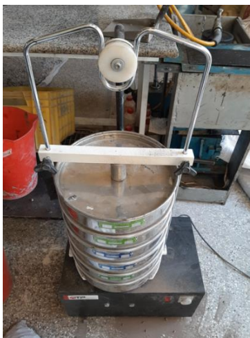
شکل ۴-۴: الکهای قرارداده شده در دستگاه لرزاننده
