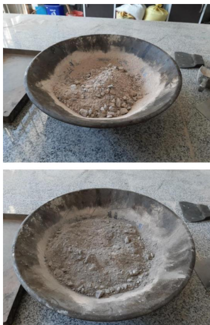
شکل ۴-۹ : مخلوط مصالح بتنی برای درصد رطوبت بهینه
