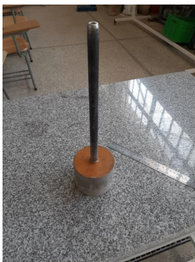
شکل ۴-۲۰ : وزنه سربار نمونه استوانه
