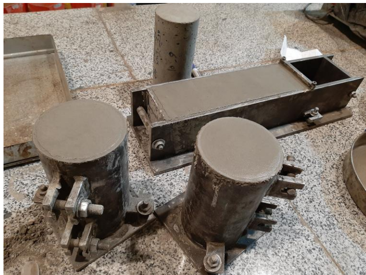
شکل ۴-۲۸: نمونه های نهایی تیر و استوانه
