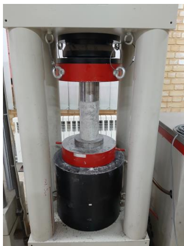
شکل ۵-۲: دستگاه آزمایش مقاومت فشاری
