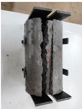
شکل ۵-۲۶: شکست نمونه استوانه ای در دستگاه آزمایش
