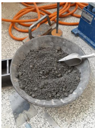
شکل ۴-۱۱ : مخلوط نهایی بتن غلتکی
