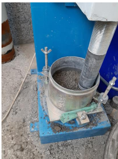
شکل ۴-۱۳ : مخلوط در حال متراکم شدن
