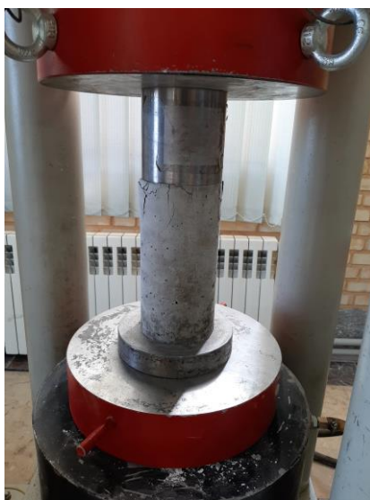
شکل ۵-۳: نمونه استوانه پس از آزمایش مقاومت فشاری
