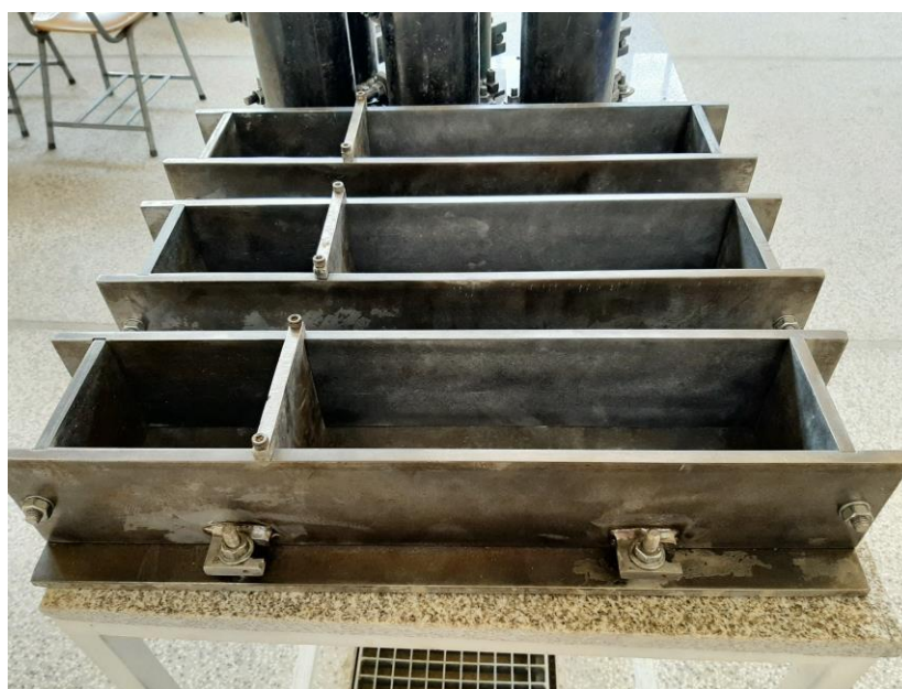
شکل ۴-۲۵ : قالب نمونه تیر
