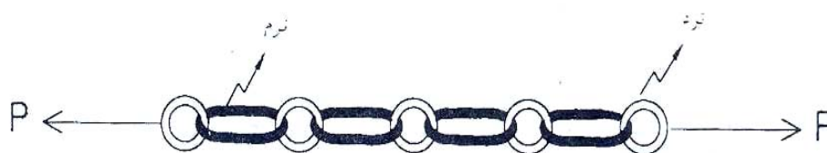
شکل (۲-۵) - نمای شماتیک زنجیر ایمن پاولی
