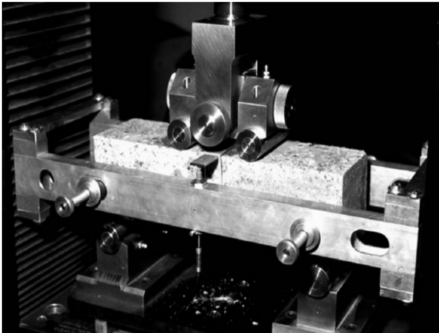
شکل ۱۰.۲: چیدمان آزمون بر اساس ASTM C1609/C1609M [۱۲]
