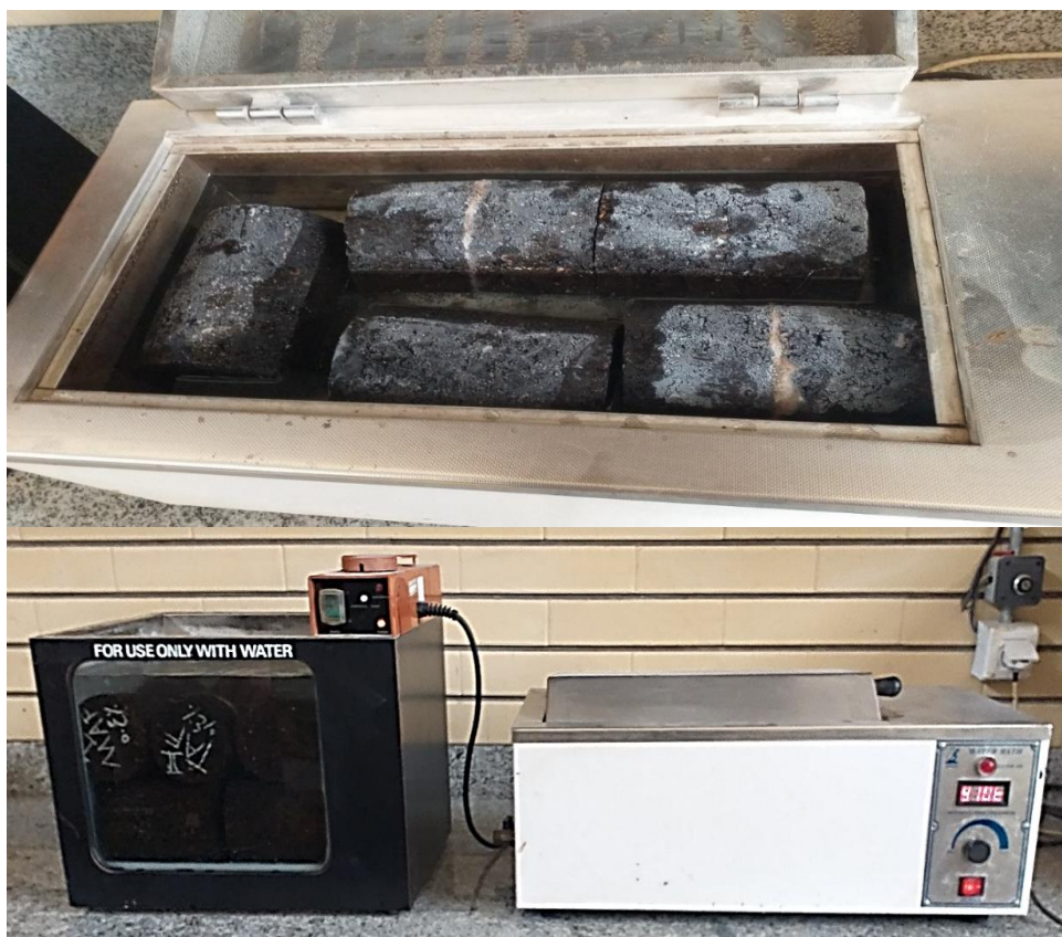
ب) نمونه‌های قرار گرفته در حمام بن ماری شکل ۳-۱۲: اعمال کاندشین ذوب و یخ
