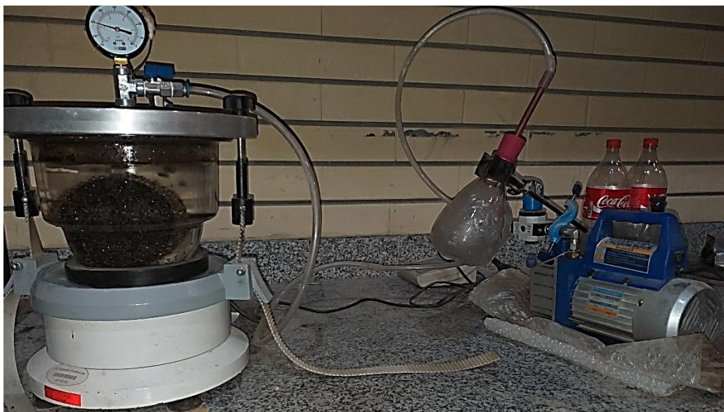
شکل ۳-۱۱: اشباع‌سازی نمونه‌ها بوسیله پمپ خلاء و دسیکاتور
