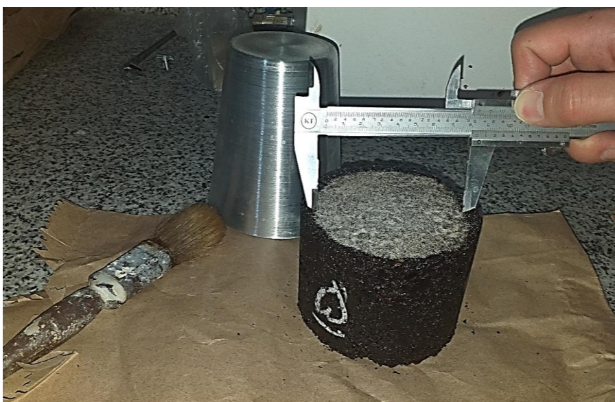
ب) قرائت قطر تقریبی دایره ایجاد شده بر روی نمونه شکل ۳-۱۷: نحوه انجام آزمایش پخش ماسه
