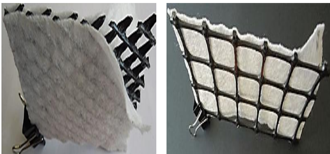
شکل ۲-۱۵: ژئوکامپوزیت ژئوتکستایل-ژئوگرید (شوکلا، ۲۰۱۷)
