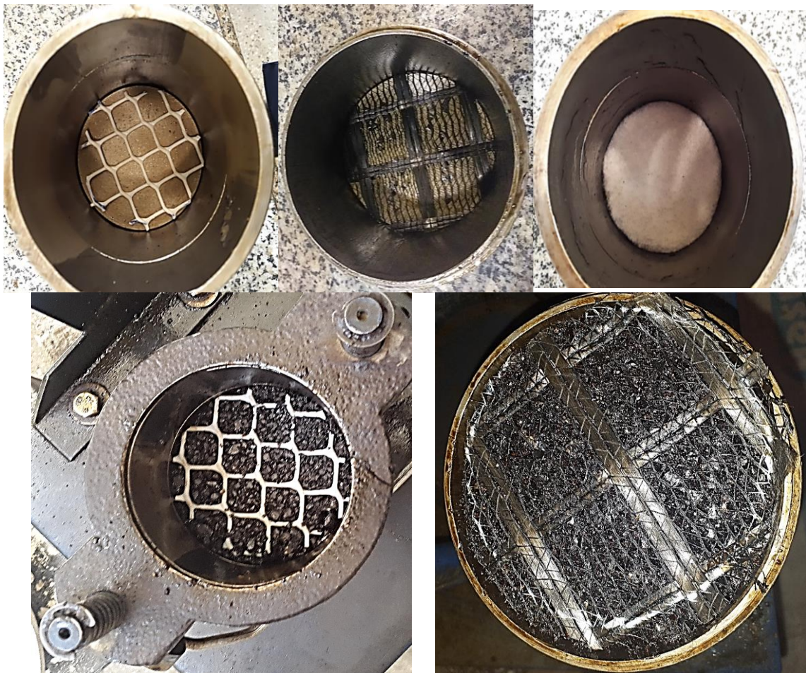
شکل ۳-۸: تصاویری از ساخت نمونه‌های آسفالتی دارای ژئوسنتتیک
