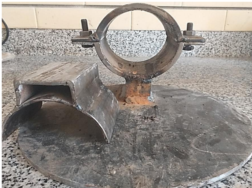
شکل ۳-۱۴: فیکسچر ساخته شده جهت آزمون برش مستقیم
