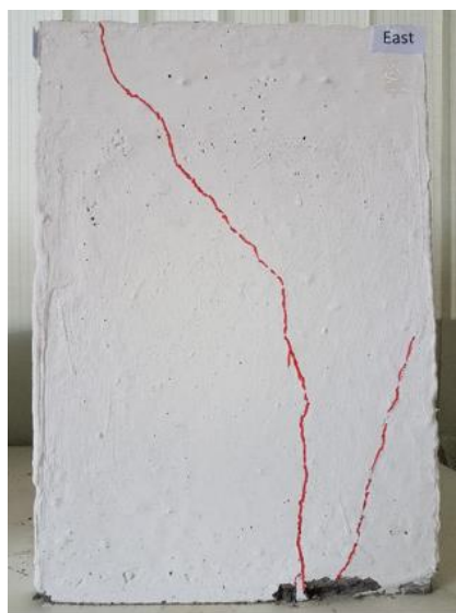
شکل ۵-۱۱۳: شرق نمونه SFRC1-C
