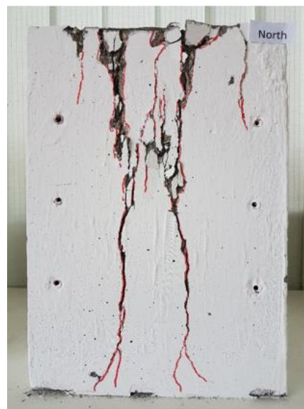
شکل ۵-۸۷: شمال نمونه SFRC1-A
