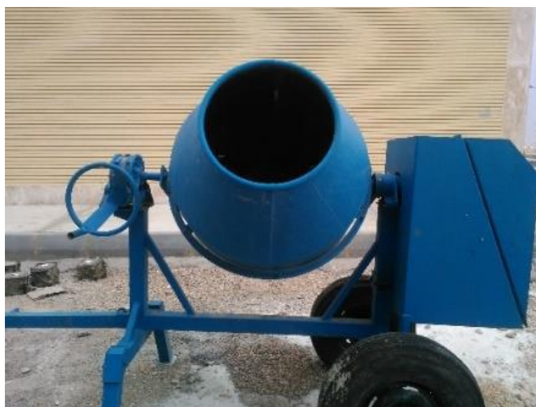
شکل ۴-۵: ماشین مخلوط کن بتن
