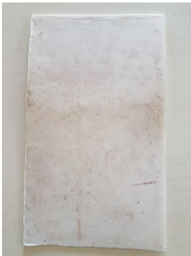
شکل ۵-۱۳: لایه پلی تترا فلورواتیلن بعد از انجام آزمایش
