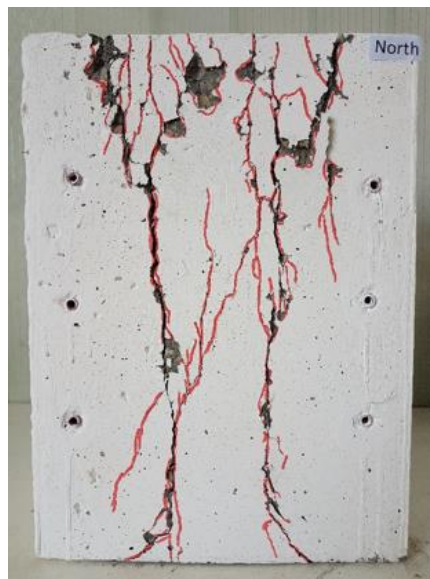
شکل ۵-۱۴۶: شمال نمونه SFRC2-C
