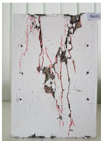
شکل ۹۸-۵: شمال نمونه SFRC1-B
