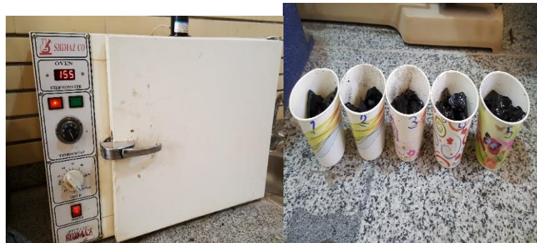
شکل ۳-۹ گرمخانه مخصوص گرم کردن قیر و شماره گذاری ظروف قیر
