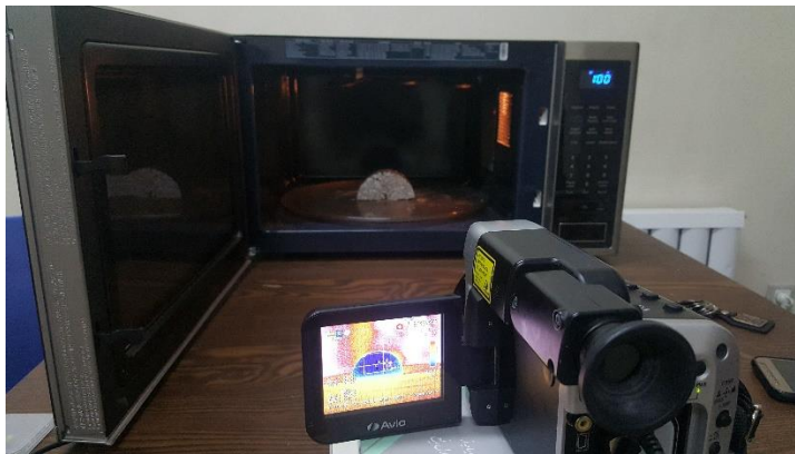
شکل ۳-۳۴ اندازه‌گیری دمای نمونه توسط دوربین حرارتی
