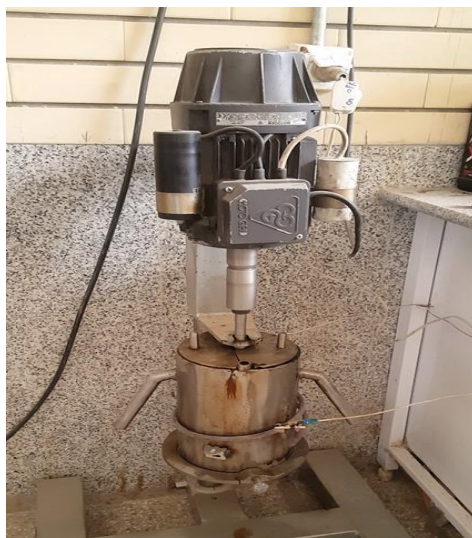
شکل ۳-۱۷ مخلوط کن دور بالا (high shear)
