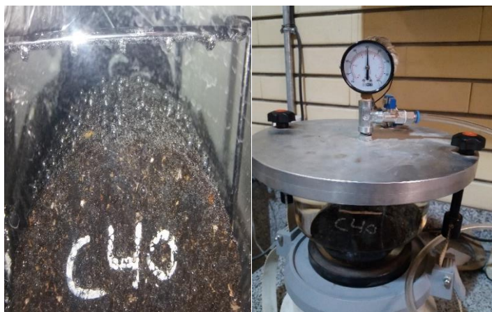
شکل ۳-۲۲ دستگاه وکیوم به منظور اشباع کردن نمونه
