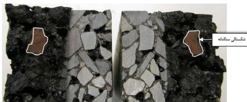
شکل ۲-۱۹ شکستگی سنگدانه بعد از آزمون خمشی [۱۶]
