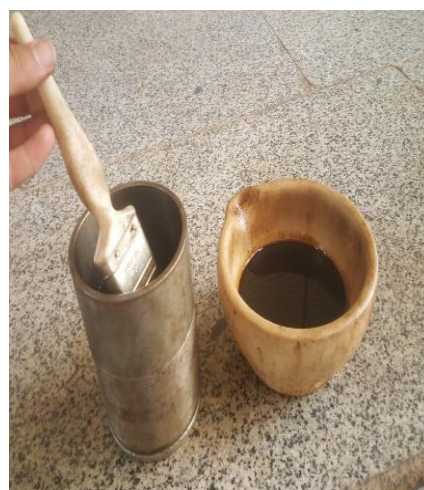
شکل ۳-۱۴ روغن کاری قالب‌ها
