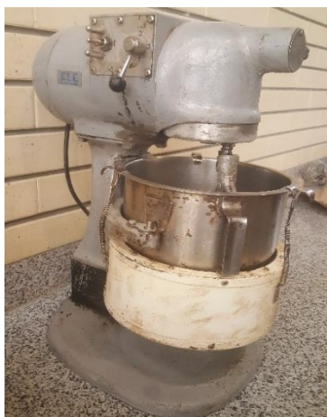
شکل ۳-۱۲ دستگاه همزن قیر و سنگدانه
