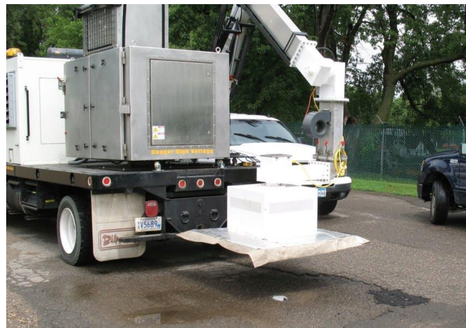
شکل ۳-۳۳ ماشین ماکروویو در عملیات میدانی ترمیم
