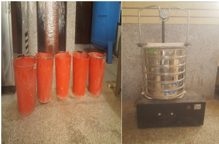
شکل ۳-۷ الک کردن مصالح و تفکیک در ظروف جداگانه
