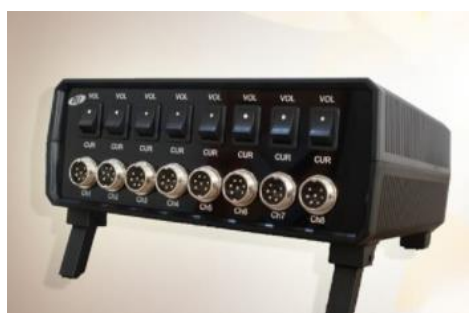
شکل ۳-۳۱ جک دستگاه خمش سه نقطه‌ای شکل ۳-۳۲ دیتالاگر ثبت داده‌های نیرو و کرنش
