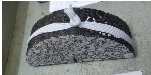
شکل ۳-۳۵ اعمال فشار ناچیز به نمونه‌ی گرمایش یافته توسط کش
