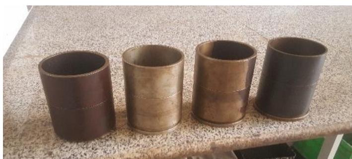
شکل ۳-۱۰ قالب های مارشال مخصوص ساخت نمونه
