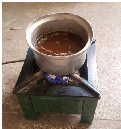
شکل ۳-۵ گرم کردن و اختلاط روغن های استفاده شده به صورت همگن
