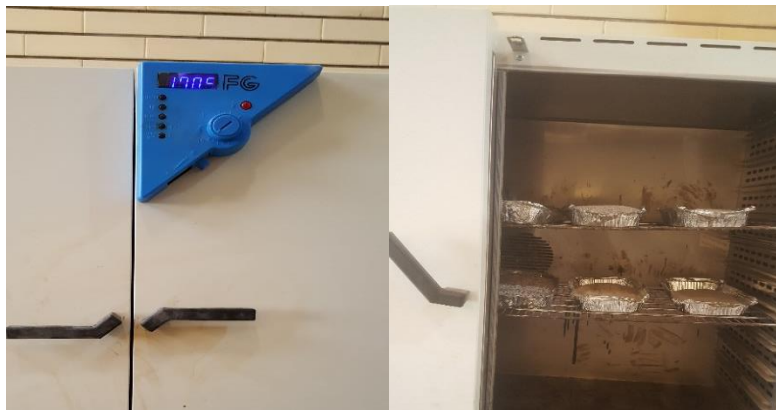
شکل ۳-۸ گرمخانه به منظور خشک کردن مصالح
