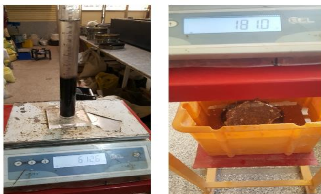
شکل ۳-۳ وزن کشی در حالت غوطه‌ور به منظور بدست آوردن وزن مخصوص حقیقی
