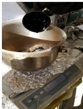
شکل ۳-۱۱ اختلاط قیر و سنگدانه
