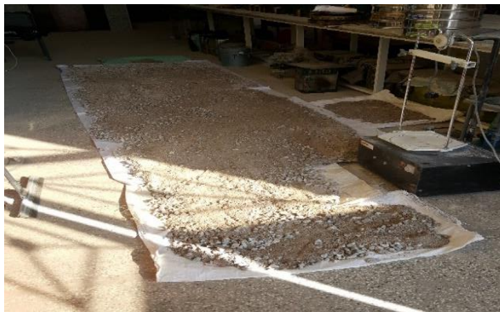
شکل ۳-۶ خشک کردن مصالح به منظور الک کردن آنان
