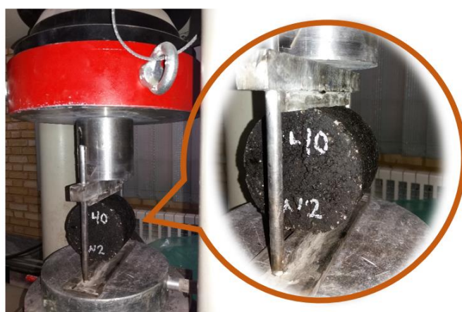
شکل ۳-۲۶ فک دستگاه کشش غیر مستقیم و اعمال نیرو در راستای قطر نمونه
