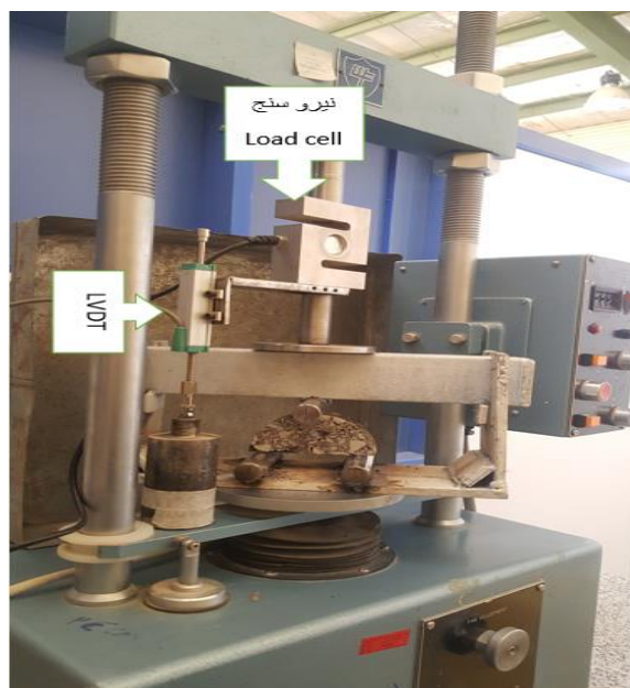
شکل ۳-۳۰ دستگاه خمش سه نقطه‌ای
