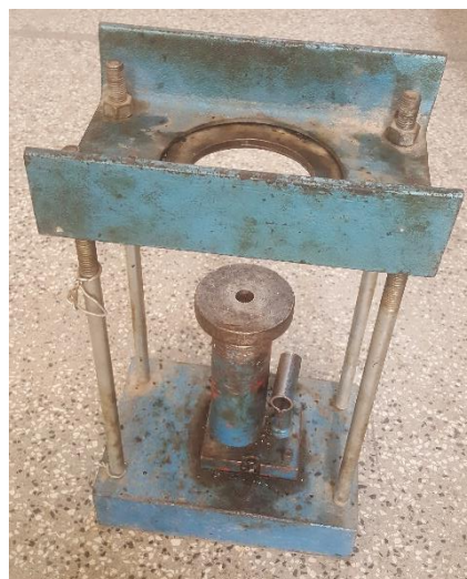
شکل ۳-۱۶ جک خارج کردن نمونه از قالب مارشال
