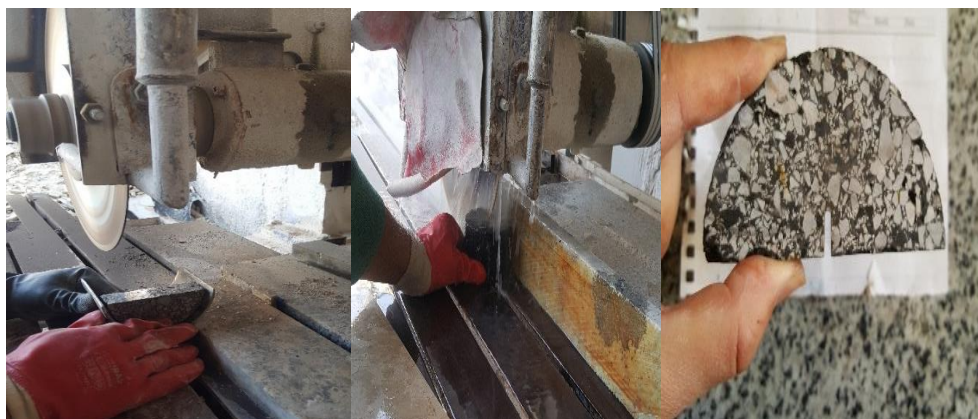
شکل ۳-۲۹ عملیات برشکاری نمونه مارشال به منظور تولید نمونه scb
