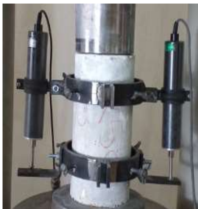
شکل ۳-۱۷- تغییر مکان سنج با دقت ۰.۰۰۵ میلی متر جهت محاسبه مدول الاستیسیته
