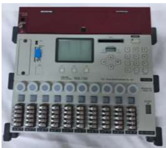
شکل ۳-۲۰- جزئیات تغییرمکان سنج و دستگاه ثبت تغییرمکان
