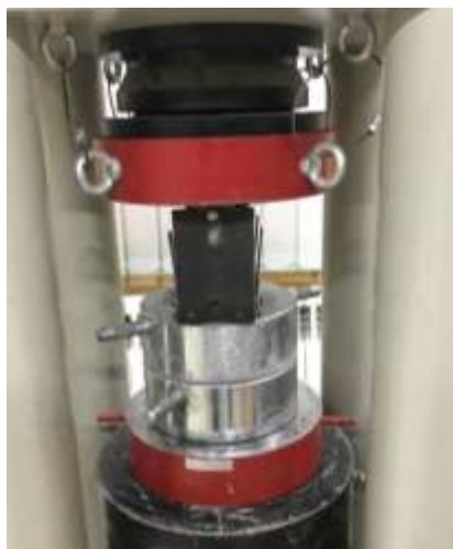
شکل ۳-۱۸- جزییات آزمایش مقاومت شکافت کششی
