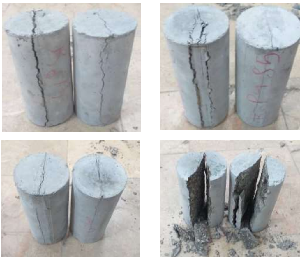
شکل ۴-۱۲- جزئیات ترک خوردگی نمونه‌های کشش غیرمستقیم
