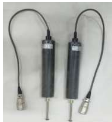
شکل ۳-۱۷- تغییر مکان سنج با دقت ۰.۰۰۵ میلی متر جهت محاسبه مدول الاستیسیته
