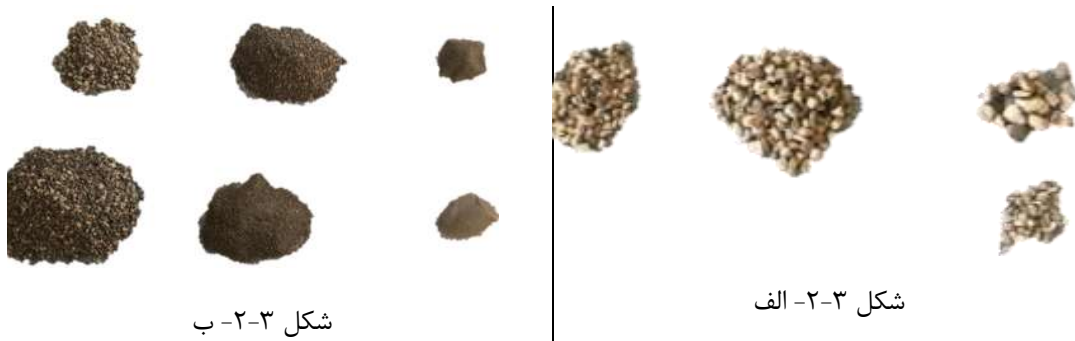
شکل ۲-۳- الف - دانه بندی درشت دانه (شن)، ب- جزئیات دانه بندی ریزدانه (ماسه)
