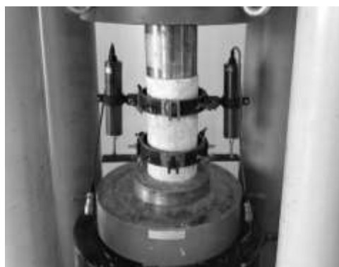
شکل ۴-۱۰- برپایش تغییرمکان سنج‌ها جهت محاسبه مدول الاستیسیته
