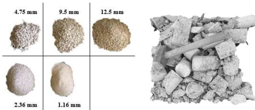
شکل ۳-۳- جزییات فرآیند خرد و سرند کردن سنگدانه‌های بازیافتی
