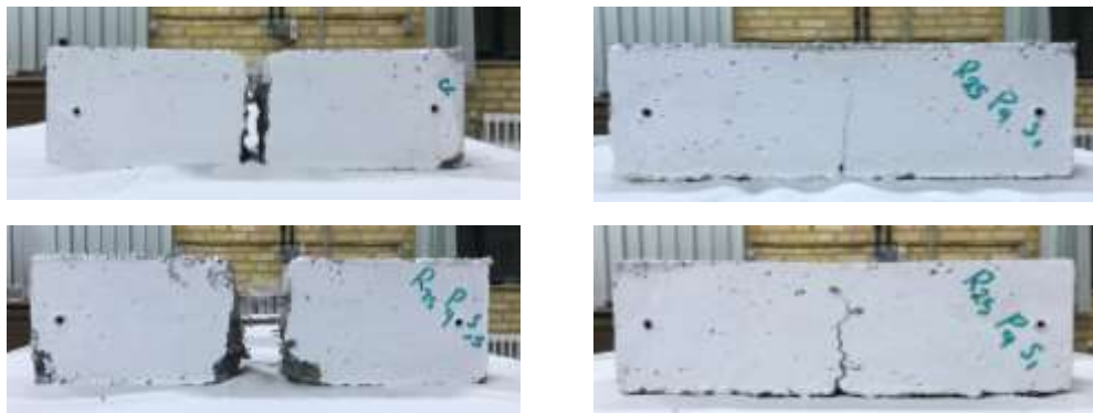
شکل ۴-۲۳- جزئیات الگوی ترک خوردگی بتن الیافی حاوی سنگدانه‌های بازیافتی
