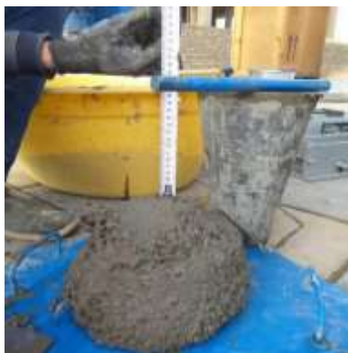
شکل ۳-۱۲- جزییات آزمایش اسلامپ بتن شاهد
