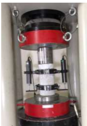
شکل ۳-۱۵- برپایش تغییرمکان سنجها جهت محاسبه مدول الاستیسیته
