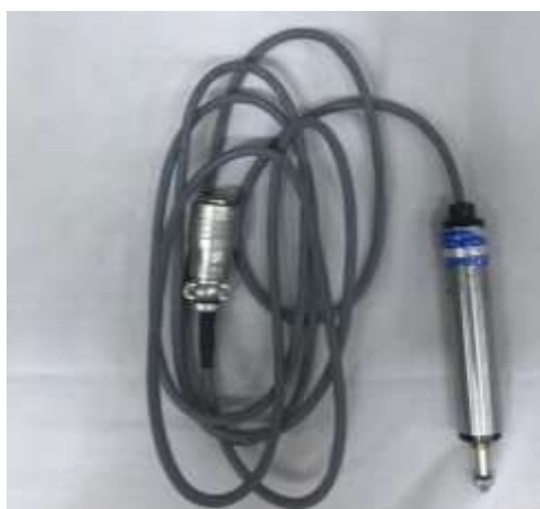
شکل ۳-۲۰- جزئیات تغییرمکان سنج و دستگاه ثبت تغییرمکان
