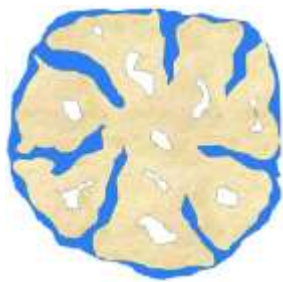
شکل ۲-۱۰- جزئیات سنگدانه کاملاً اشباع
