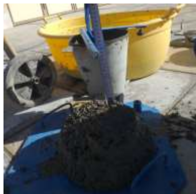
شکل ۳-۱۲- جزییات آزمایش اسلامپ بتن شاهد
