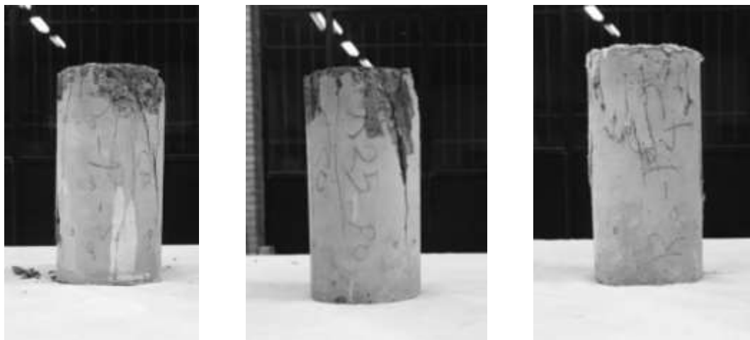
شکل ۴-۵- الگوی ترک خوردگی بتن الیافی حاوی سنگدانه‌های بازیافتی
