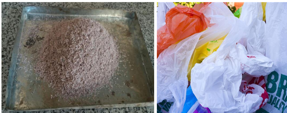
شکل ۲-۴. پلی اتیلن های ضایعاتی قبل و بعد از خرد شدن
