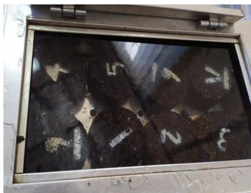
شکل ۳-۴. قرار دادن نمونه‌ها در آب ۶۰ درجه به مدت ۲۴ ساعت
