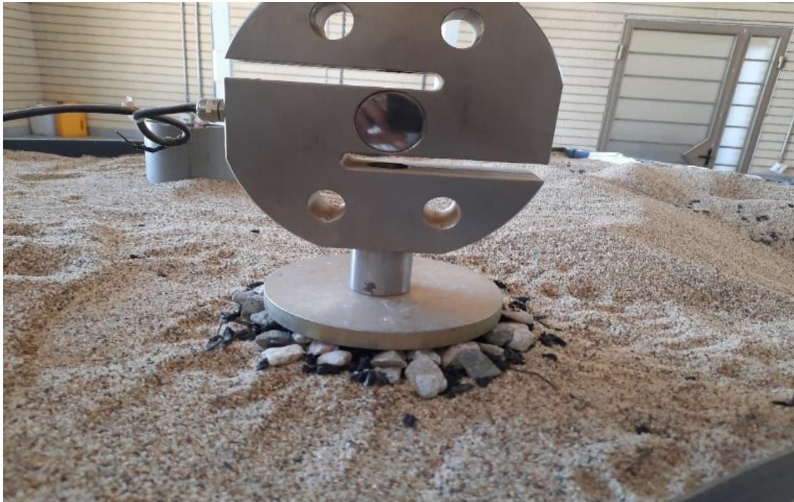
شکل (۳-۱۱) عملیات بارگذاری ستون شنی
