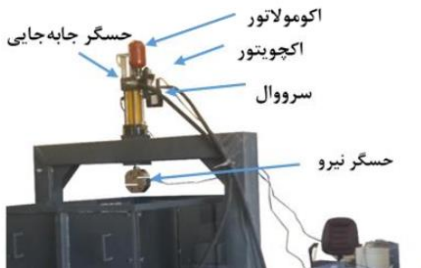
شکل (ب-۴) اجزا سیستم اکچویتور
