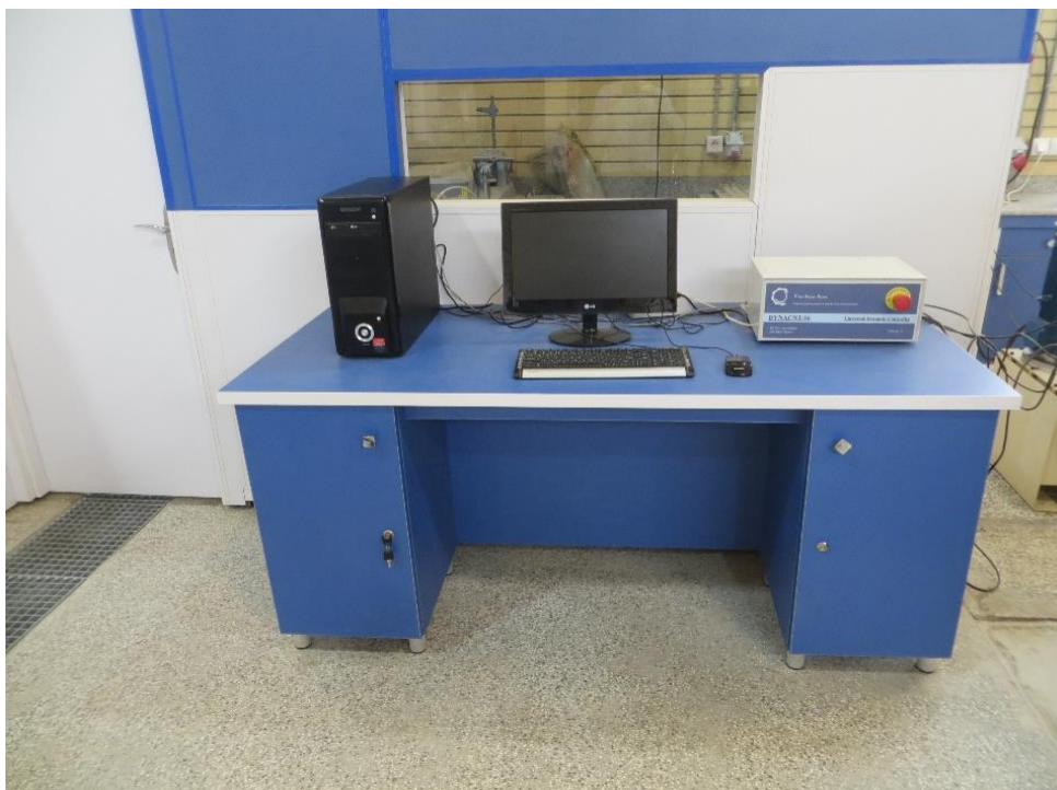
شکل (ب-۶) سیستم کامپیوتری کنترل، قرائت و ثبت داده‌ها
