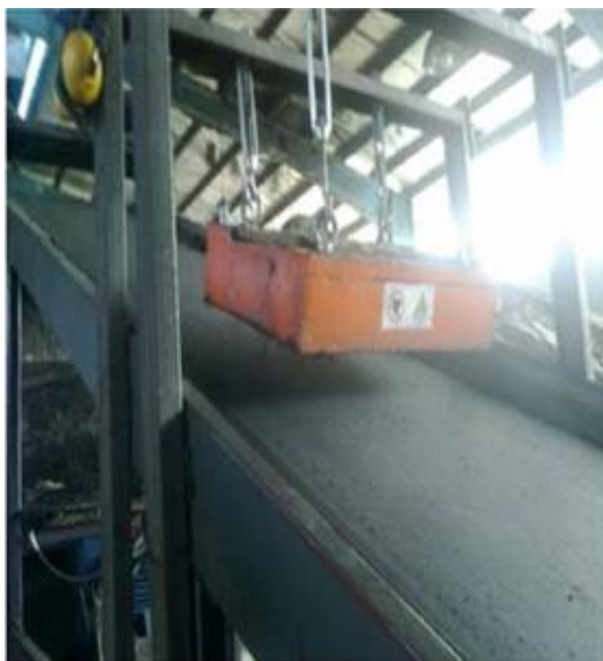
شکل (۸-۲) آهن‌ربا برای جدا کردن ناخالصی فلزی [۷]
