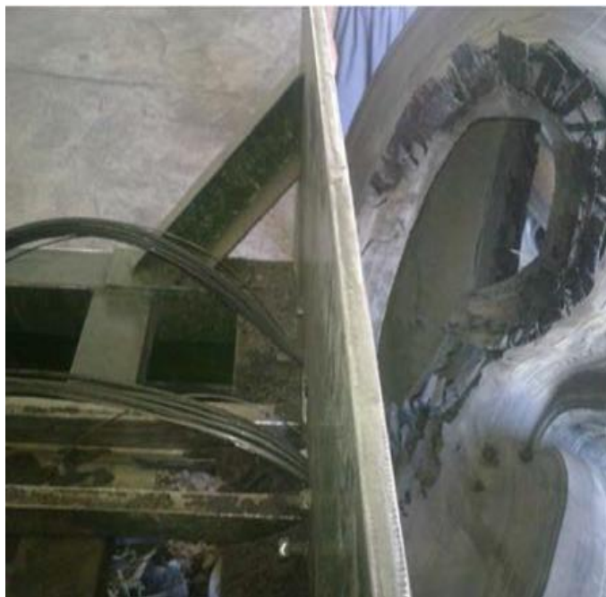
شکل (۷-۲) جدا نمودن مفتول‌های فلزی جمع‌آوری شده الاستیک‌ها [۷]
