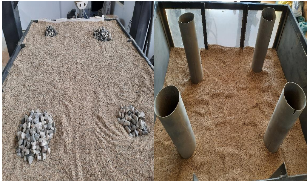
شکل (۳-۱۰) پر کردن دستگاه مدل‌سازی فیزیکی
