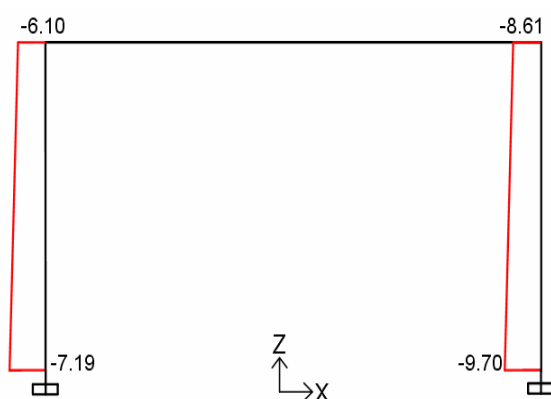
شکل ۳-۱۶ نیروی محوری تحت بار جانبی در حالت عدم اتصال دیوار با قاب
