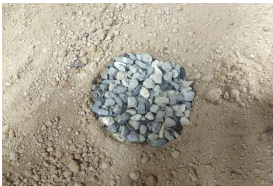
شکل (۳-۱) مدل سازی ستون شنی و خاک اطراف در جعبه دستگاه اودومتر [۵۷]
