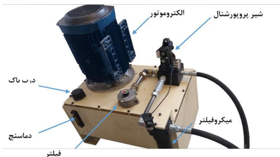
شکل (ب-۳) سیستم پاورپیک
