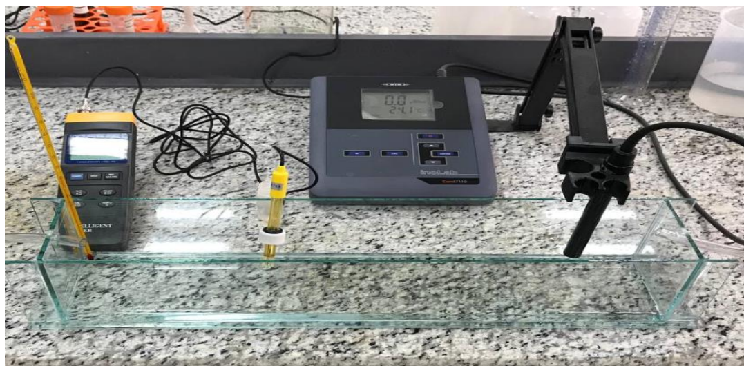
شکل ۳-۷ نحوه قرار گیر سنسورها درون کانال اندازه‌گیری
