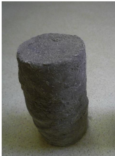
شکل ۲-۸ خاک مسلح شده با ضایعات پلاستیکی
