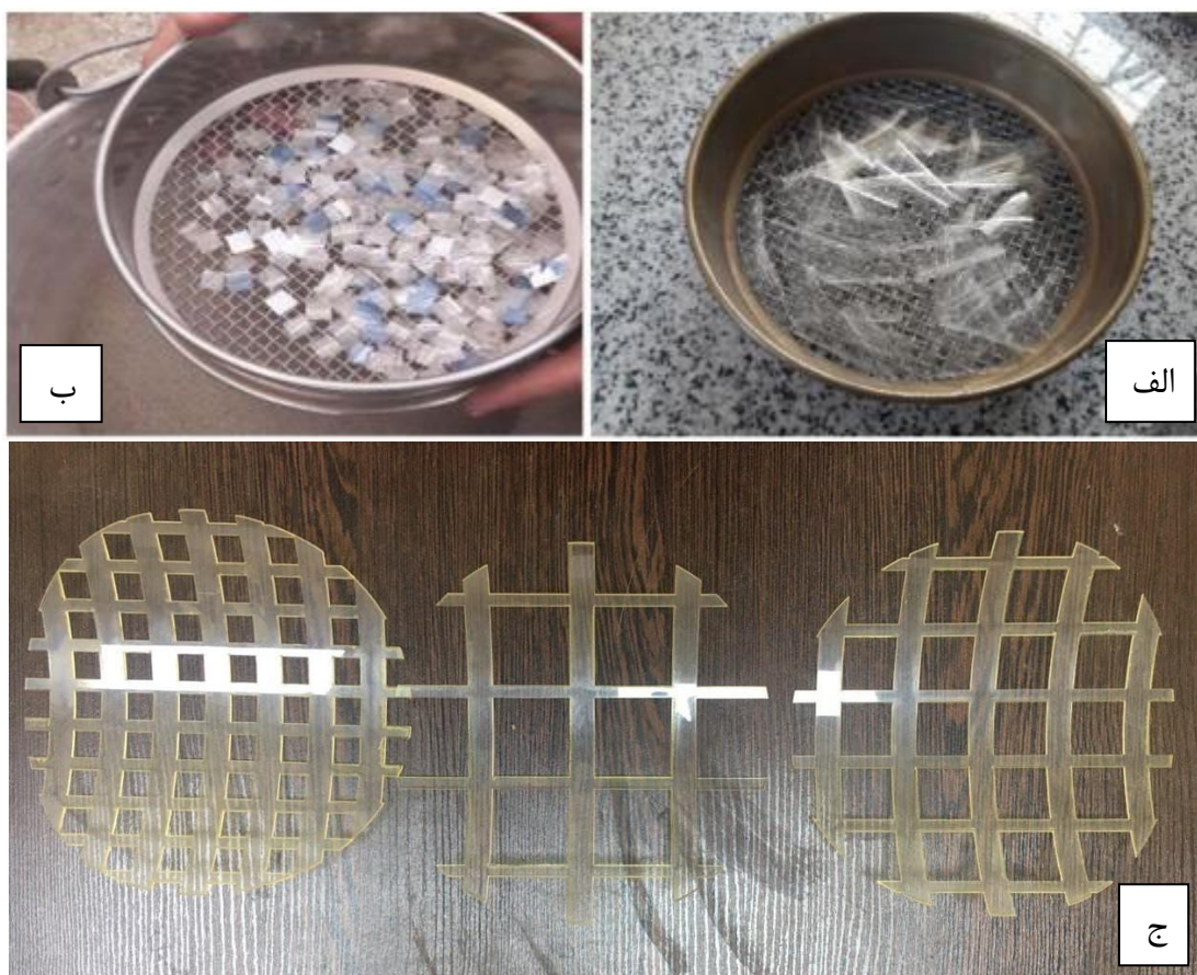
شکل ۲-۳ PETهای مصرفی در این پژوهش الف: PET نواری، ب: PET خرد، ج: Geopet
