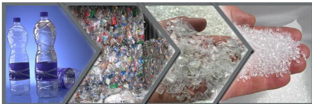
شکل ۱۱-۲ فرایند بازیافت و تبدیل پلاستیک‌های ضایعاتی به گرانول‌های پلیمری قابل ذوب مجدد
