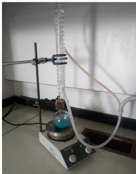
شکل ۳-۶- شرایط آزمایشگاهی سنتز HKUST-1 (سیستم رفلکس)
