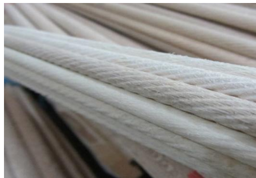
شکل ۳-۱۸: هسته چوبی استفاده شده برای میله‌های MMFRP
