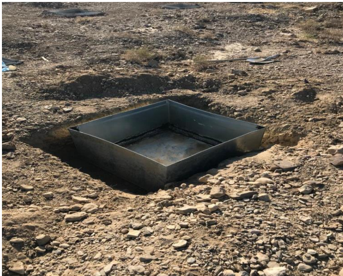
شکل (۲-۲) تشت تبخیر استاندارد کلرادو
