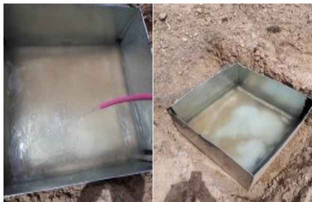
شکل (۳-۱۰) نمونه‌ای از آبیگری تشت به منظور تست و عدم نشتی
