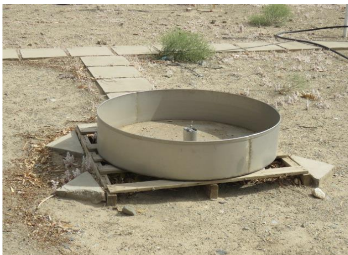
شکل (۱-۲) تشت تبخیر کلاس A ایستگاه سینوپتیک
