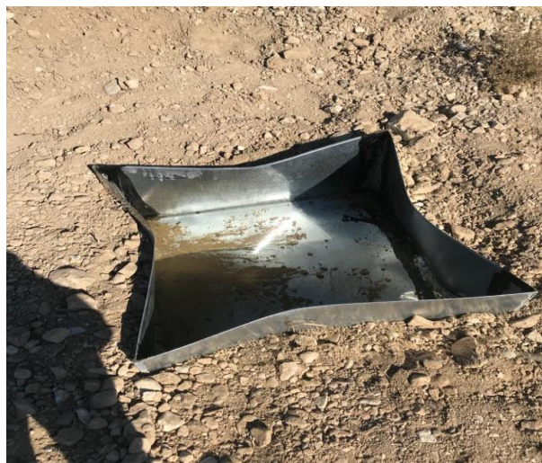
شکل (۵-۳) تغییر شکل تشت‌ها
