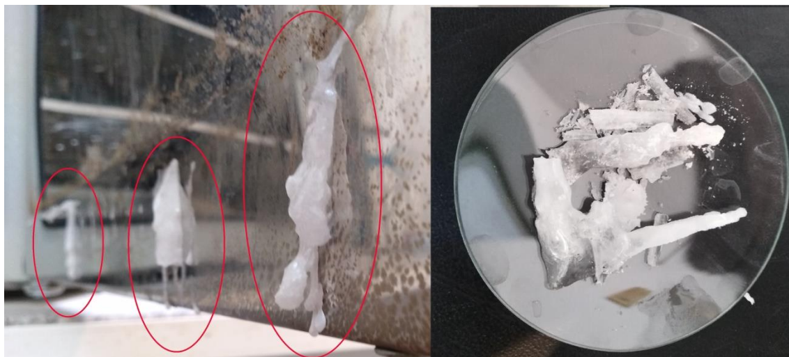
شکل ۳-۴. شکل‌گیری قندیل‌های نفتالین در جداره آون و جمع‌آوری آن
