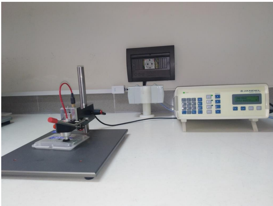
شکل ۳-۷. دستگاه اندازه‌گیری مقاومت سطحی چهار نقطه‌ای دانشکده فیزیک دانشگاه صنعتی شاهرود
