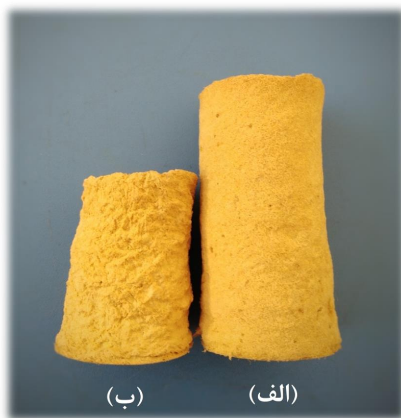
شکل ۴-۴. تفاوت آئروژل ساخته‌شده به صورت خشک‌سازی (الف) دو مرحله‌ای و (ب) تک مرحله‌ای
