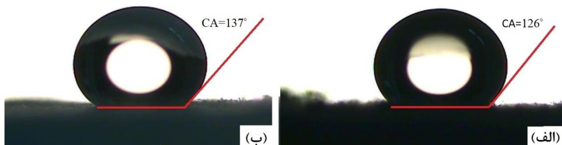
شکل ۴-۱۶. نتایج آزمون زاویه تماس قطره برای آئروژل‌ها (الف) کربنی و (ب) سلولزی آب‌گریز
