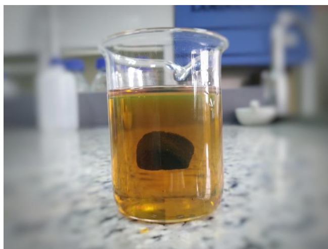
شکل ۴-۲۰. تصویر غوطه‌وری آئروژل کربنی در روغن موتور به‌منظور بررسی ظرفیت جذب روغن
