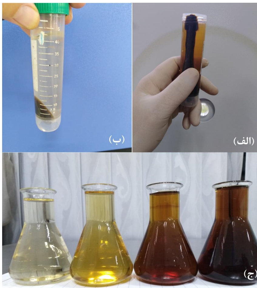
شکل ۴-۲۴. سنتز نانو ورقه‌های GO (الف) قبل و (ب) بعد از شستشو، (ج) روند شفاف شدن آب حاصل از شستشو ذرات GO طی چهار مرحله
