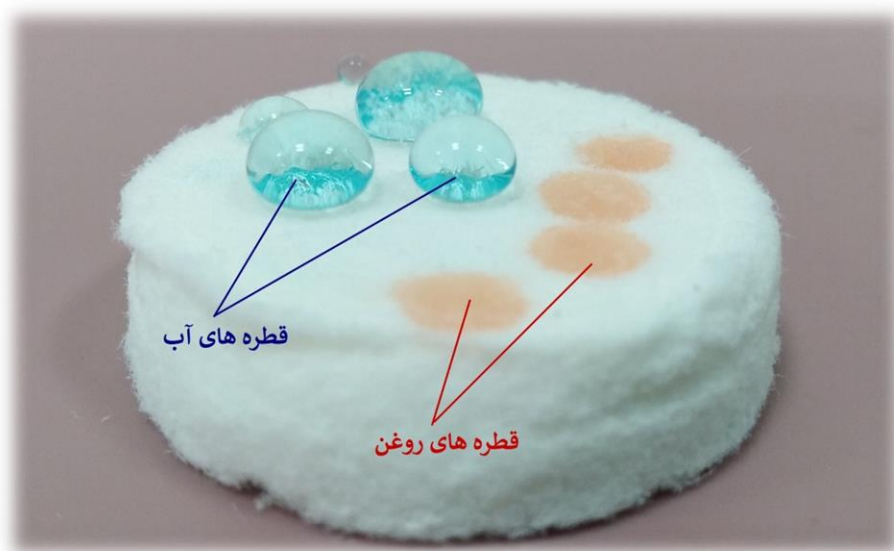
شکل ۴-۱۷. تصویر نفوذ قطرات روغن و عدم نفوذ قطرات آب درون آئروژل سلولزی آب‌گریز شده
