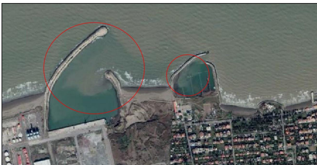
شکل ۵-۵ شواهدی از وجود لکه‌های رسوبی در حوضچه بندرهای فریدونکنار و دریابانی.
