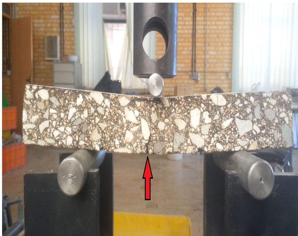
شکل (۳-۱۳) ایجاد ترک در نمونه‌ی آسفالتی تحت آزمایش خمش
