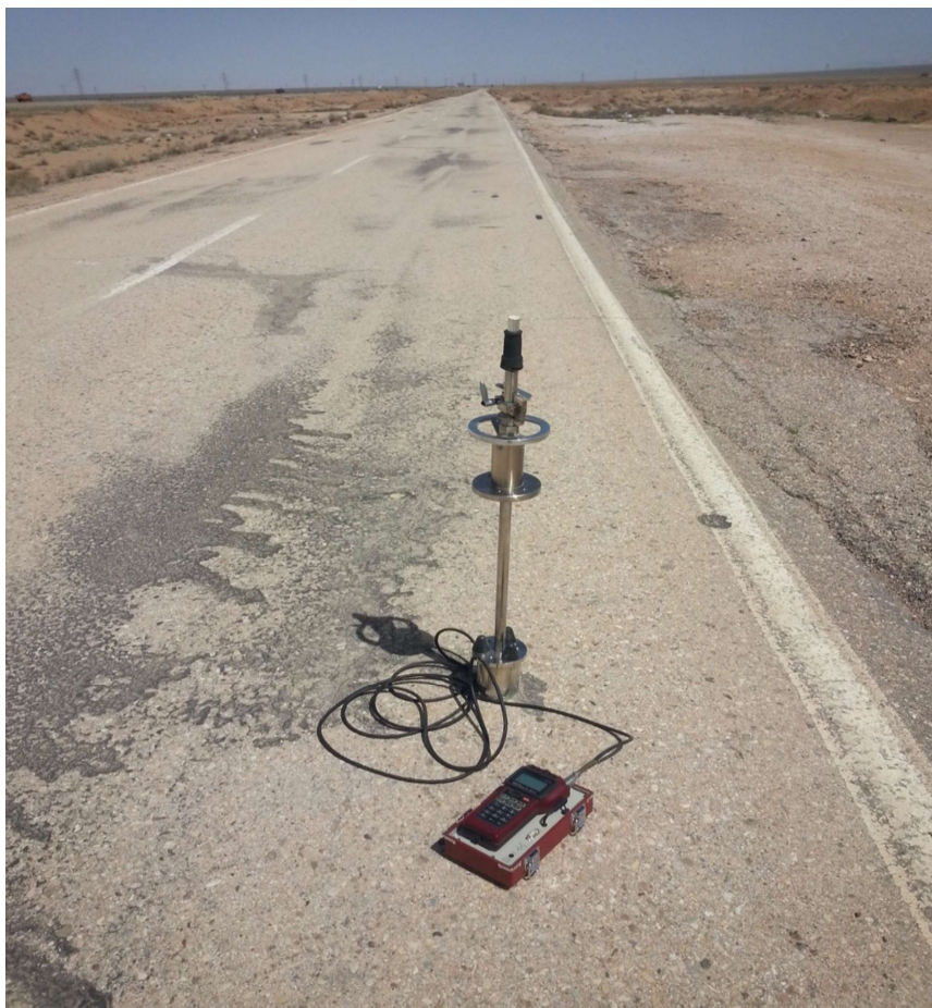
شکل (۳-۴) دستگاه PFWD ساخت شرکت TML ژاپن
