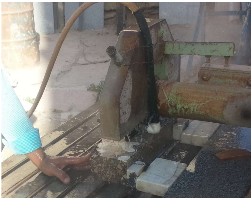
شکل (۳-۸) برش نمونه‌های تیری شکل در ابعاد استاندارد با دستگاه برش سنگ
