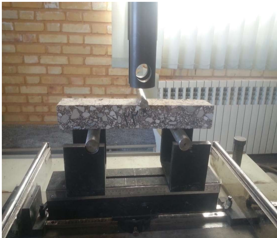
شکل (۳-۱۲) نحوه‌ی قرار گیری نمونه‌ی تیری شکل در آزمایش خمش سه نقطه
