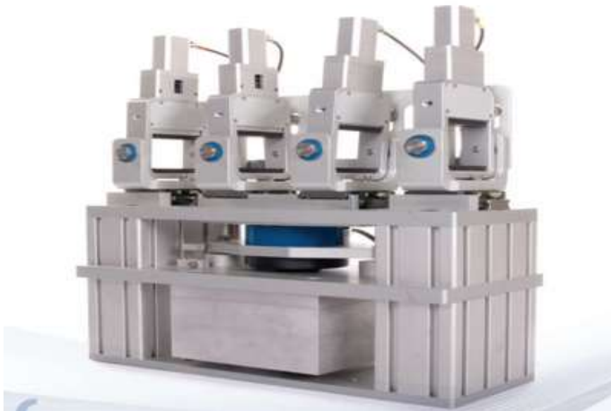
شکل (۳-۵) اجزای دستگاه خستگی چهار نقطه‌ای
