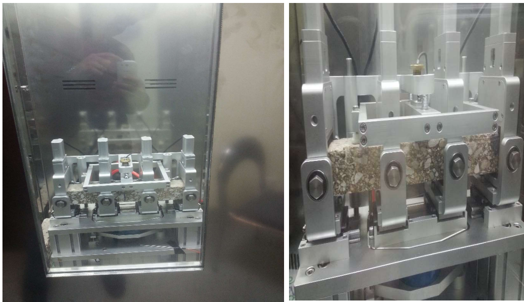
شکل (۳-۱۰) دستگاه آزمایش خستگی چهار نقطه‌ای
