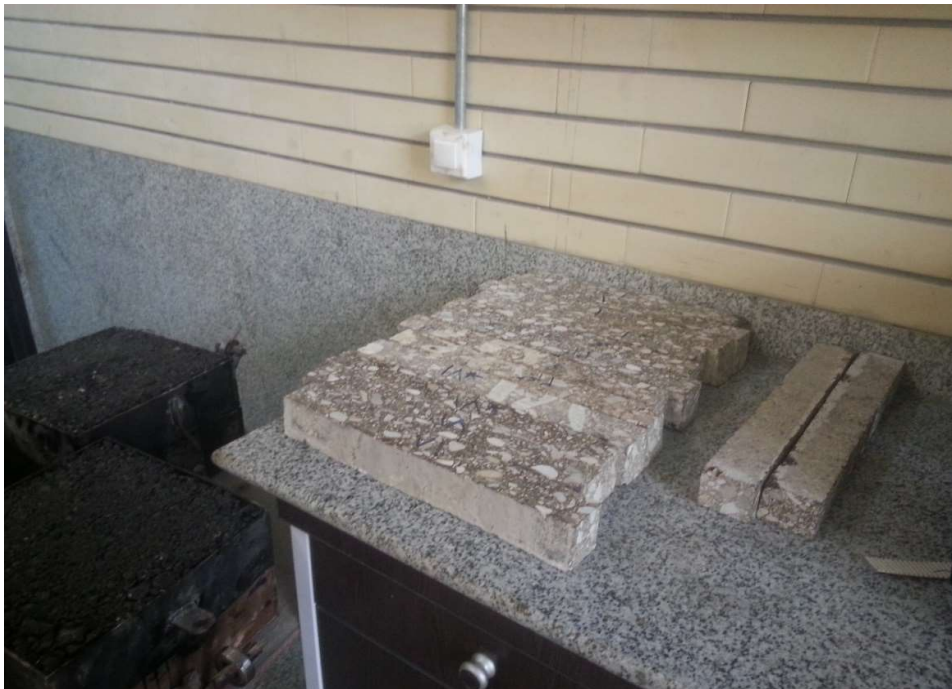
شکل (۳-۹) نمونه‌های تیری شکل در ابعاد استاندارد آزمایش خستگی
