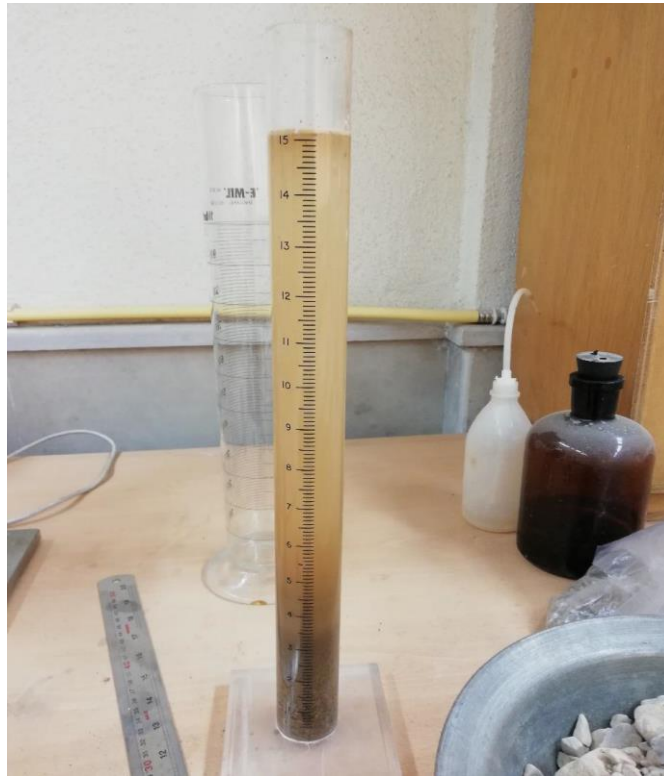
شکل (۳-۵) آزمایش ارزش ماسه‌ای
