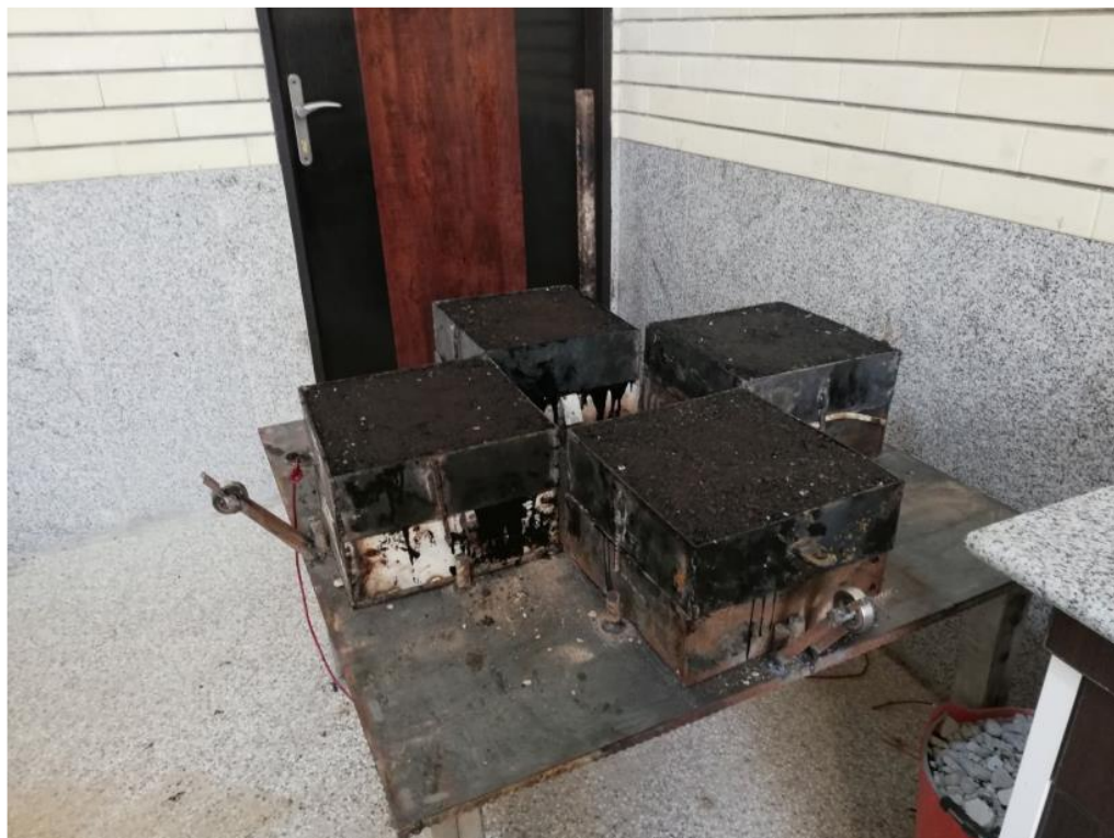
شکل (۳-۱۰) دستگاه اندازه‌گیری مقاومت اندود بین آسفالت و اساس
