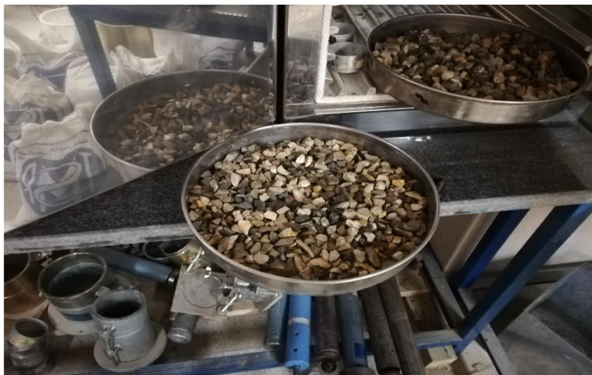
شکل (۳-۴) آزمایش تعیین درصد جذب آب وزن مخصوص درشتدانه
