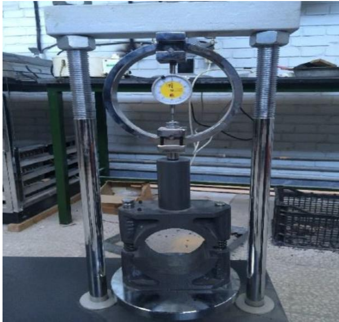
شکل (۳-۸) دستگاه مقاومت مارشال
