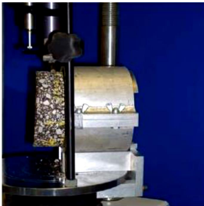
شکل (۱۲-۲) آزمایش نیروی برشی
