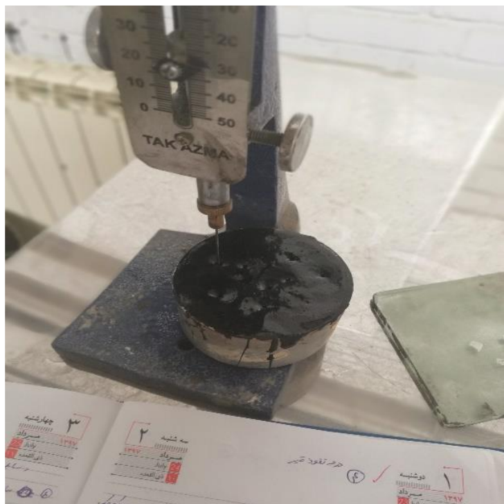
شکل (۳-۶) آزمایش درجه نفوذ قیر
