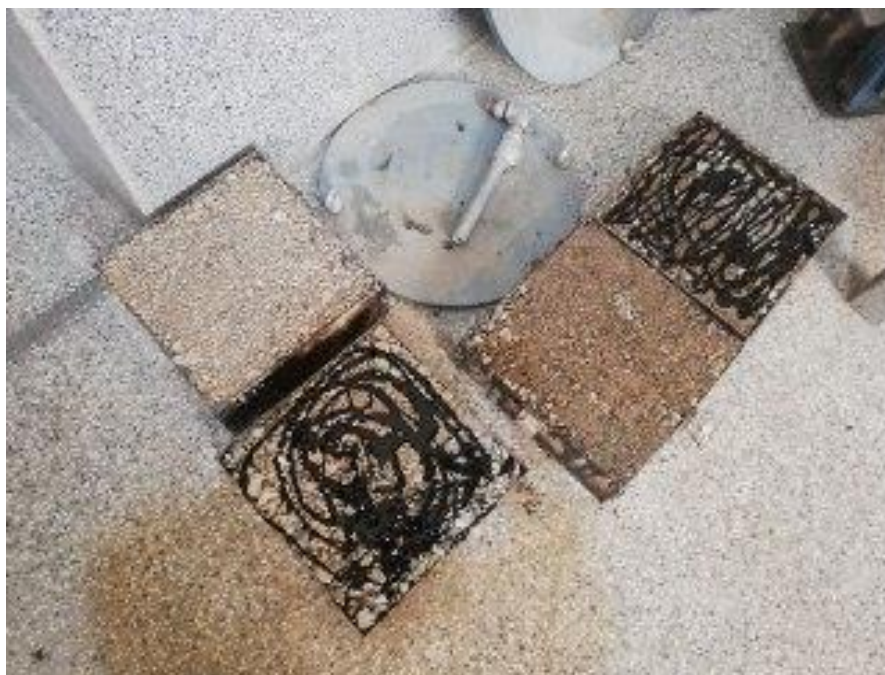
شکل (۱۵-۳) ریختن اندود روی اساس خشک و مرطوب
