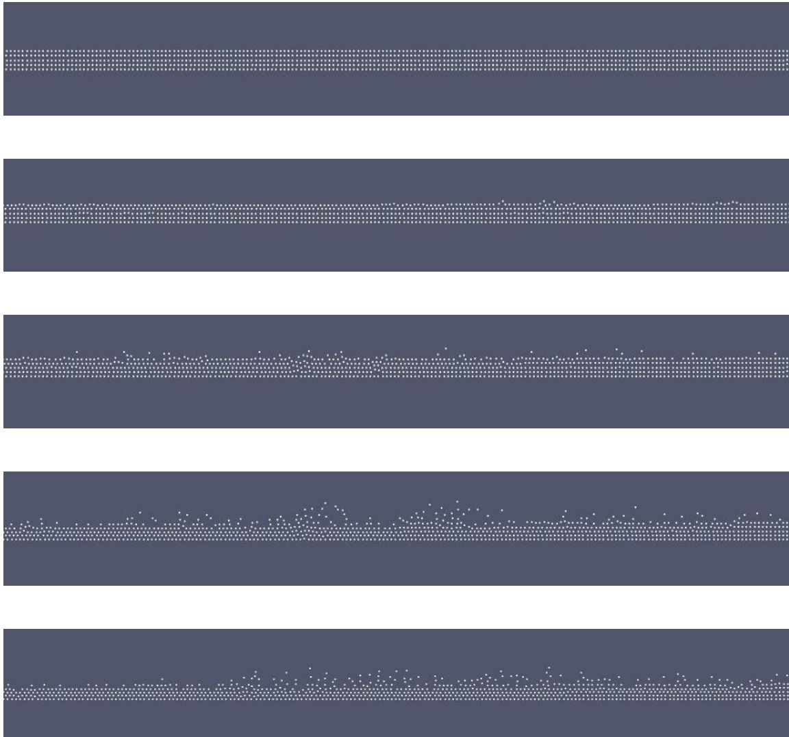
شکل ۴-۳۷ مراحل مختلف به آستانه حرکت رسیدن ذرات رسوب در Re^* = 910
