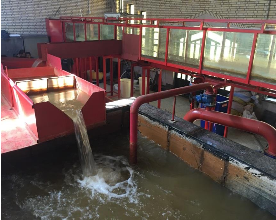
شکل ۳-۵- سرریز مثلثی نصب شده به منظور اندازه‌گیری دبی جریان خروجی از کانال فرعی
