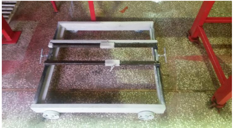
شکل ۳-۲- تکیه‌گاه ریلی و ارابه روی آن
