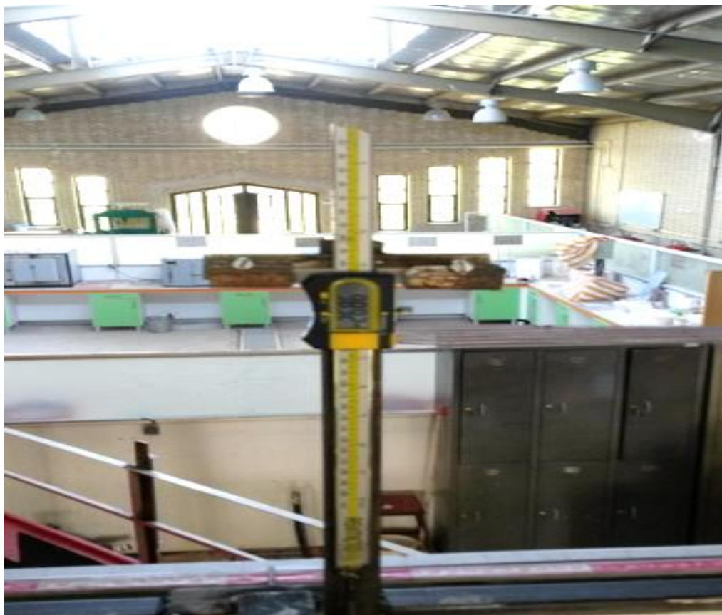
شکل ۳-۷- نمای از عمق سنج دیجیتالی
